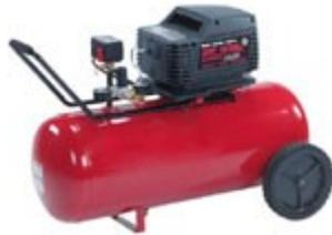
**Compresor de aire** Se utiliza para inflar y mantener la presión en la vejiga de la prensa. Este compresor debe ser capaz de ofrecer hasta 100 psi de presión. También deberá contar con la posibilidad de regular la presión necesaria para que la vejiga mantenga la presión vertical constante durante varias horas, hasta que el epoxi se cure completamente
