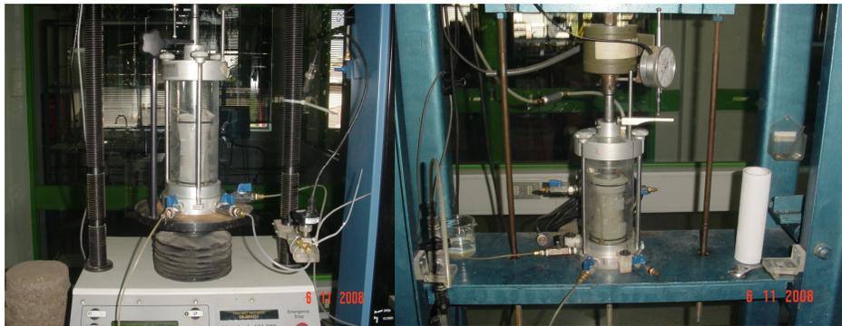
**Figura 3.5: Montaje de la Probeta**
