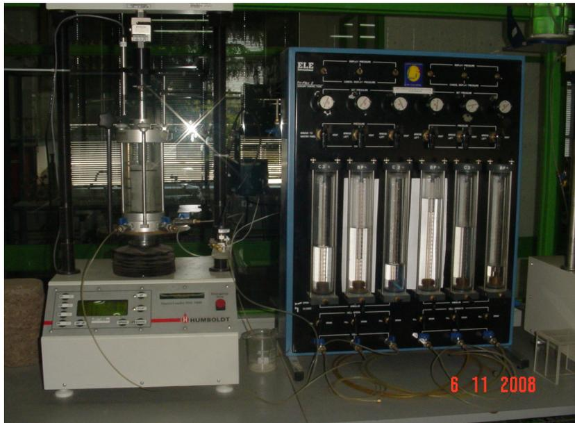
**Figura 3.1: Equipo Triaxial Estático**
