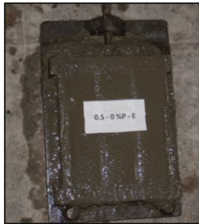
Figura 4.16: Molde RILEM lleno con mortero.
