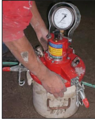
Figura 4.12: Equipo de ensayo de contenido de aire.
