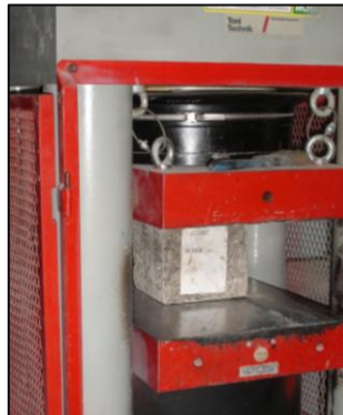
Figura 4.15: Equipo de ensayo de resistencia a la compresión.
