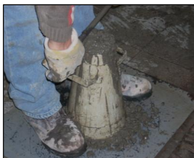
Figura 4.10: Equipo de ensayo de asentamiento de cono de Abrams.
