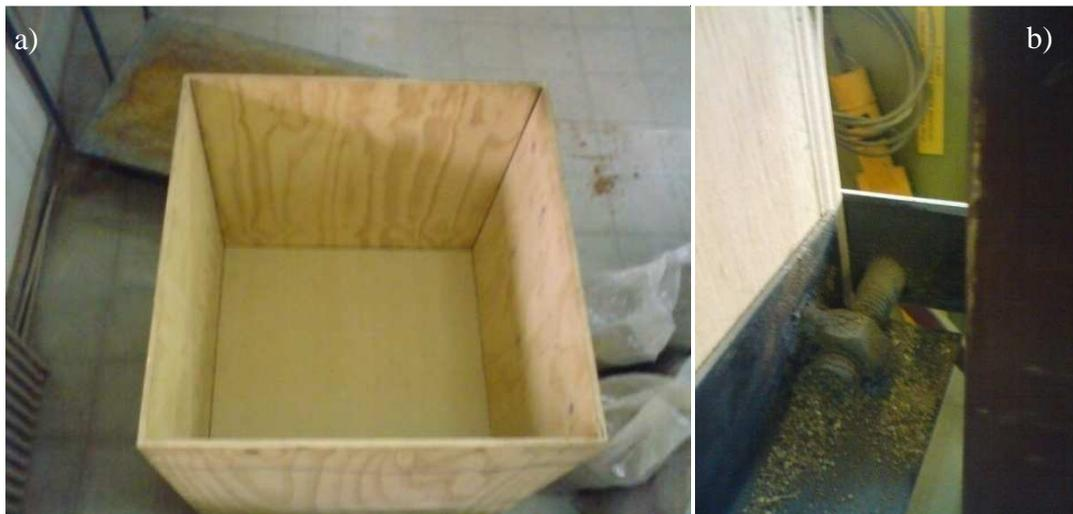
*Figura 4. 19: a) Contenedor de madera y b) perfiles para evitar flexión de las paredes*
