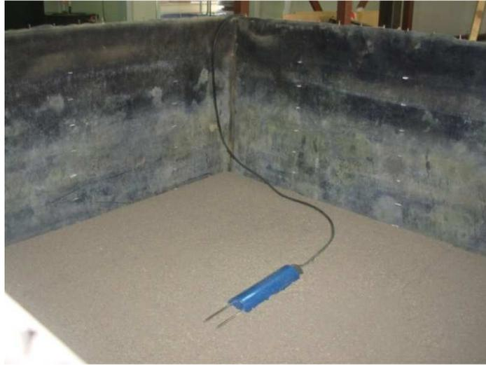
*Figura 4. 22: Sensor P20 colocado en la caja a 20 cm de profundidad.*
