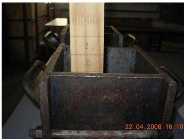
Figura 4. 6: Molde y elemento para compactar cada capa
