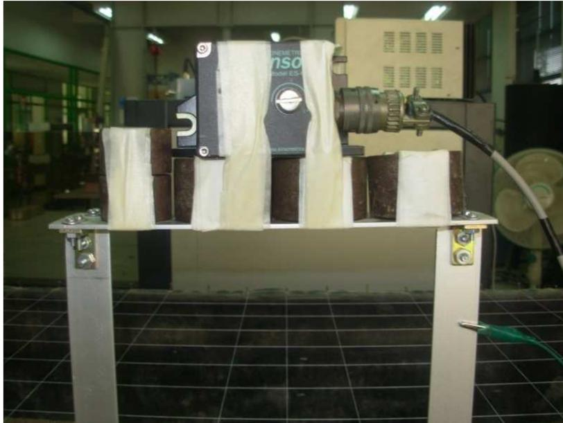
Figura 3. 3: Sensor EPISensor ES-U2 utilizado en los ensayos con mediciones ambientales
