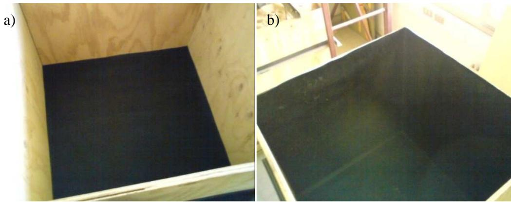
Figura 4. 20: Sellado interno del contenedor a) sellado fondo b) sellado en los costados
