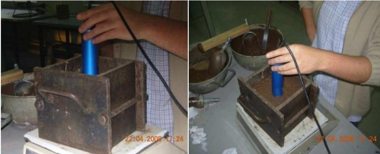
*Figura 4. 8: Proceso de medición para calibración de los sensores de humedad*
