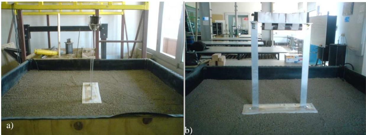
*Figura 4. 25: a) Vistas de perfil y b) vista de frente de la estructura a escala fundada en el modelo*
