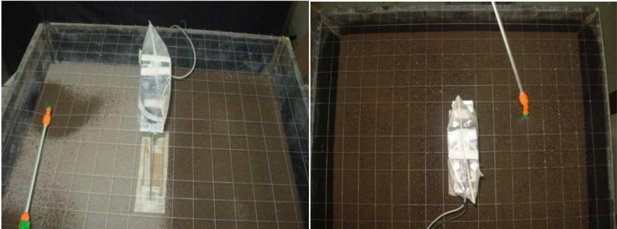
*Figura 4. 31: Simulación de efecto de lluvia producto del dispensador de agua*
