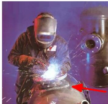
Figura 3.6: Abertura reforzada de piping de presión con el material aportado externamente mediante soldadura.
