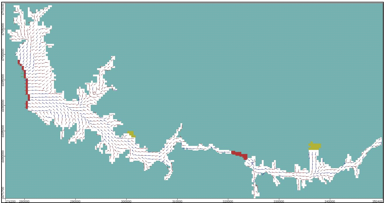
Figura 4-33 Dirección del flujo subterráneo en estrato inferior (periodo 60 de calibración)
