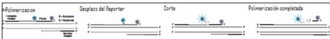
Figura 2: Sondas Taqman. Representación de la actividad 5' nucleasa de la Taq polimerasa actuando sobre una sonda fluorescente durante la fase de extensión de la PCR.
