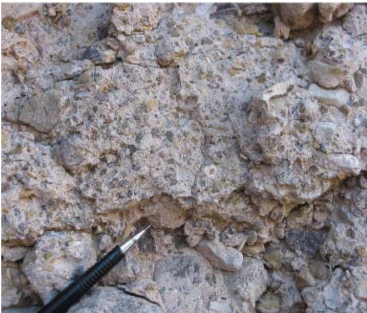
**Figura 3.11. Gravas matriz soportadas cementados por carbonato.**
