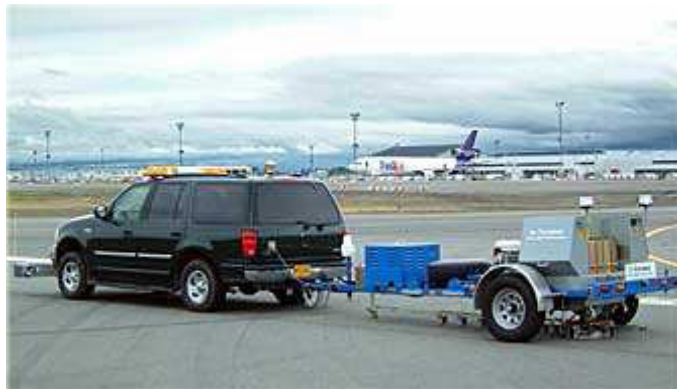
Figura 12: Mediciones con el deflectómetro de impacto (FWD)
