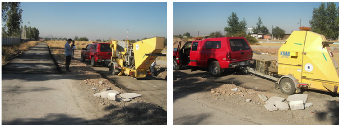
Figura 42: Mediciones deflectómetro del LNV en pista sobre base granular
