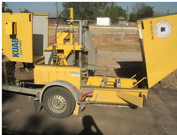
Figura 41: Mediciones deflectómetro del LNV en pista sobre base granular
