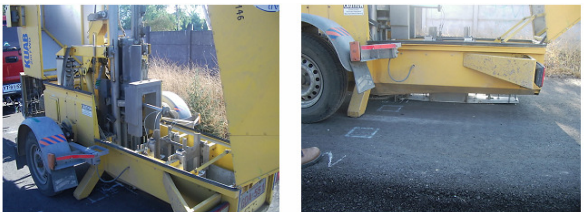
Figura 14: Partes del deflectómetro a) sistema generador de carga, b) sensores deflexión
