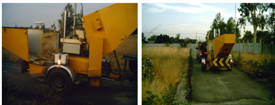
Figura 43: Medición con el deflectómetro de GAUSS S.A. en pista sobre hormigón.
