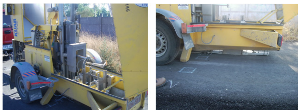
Figura 40: Mediciones deflectómetro del LNV en pista sobre hormigón
