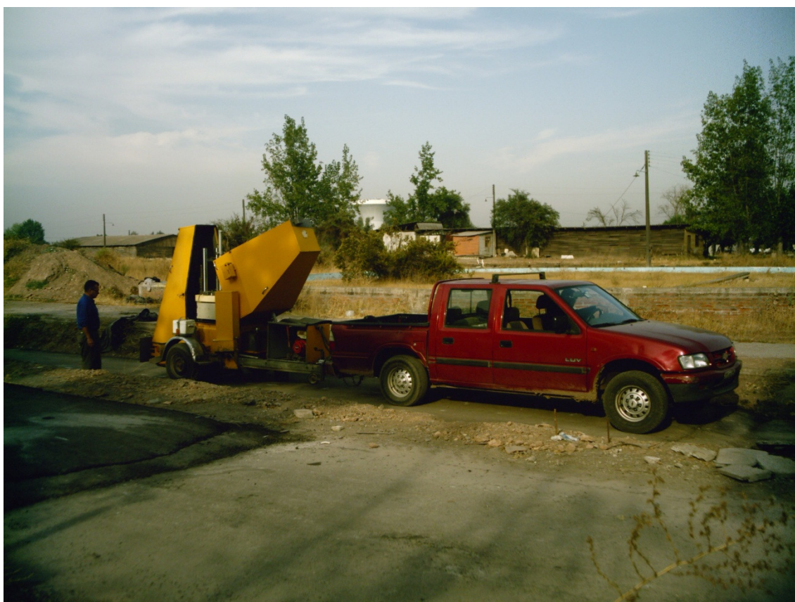
Figura 44: Medición con el deflectómetro de GAUSS S.A. en pista sobre base granular
