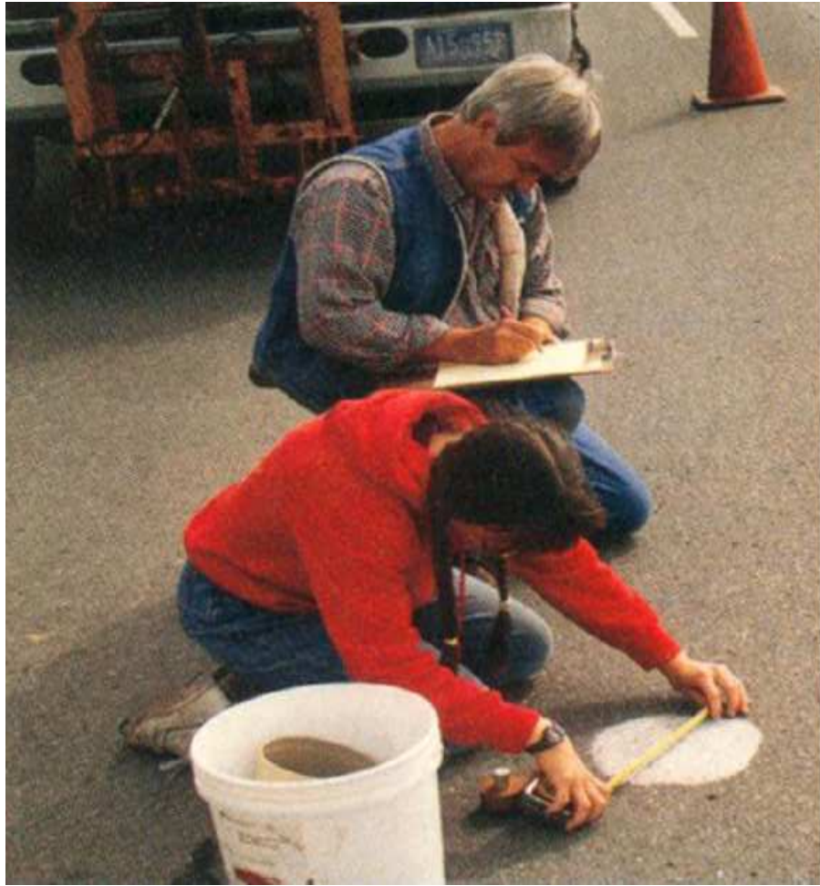
Figura E.3: Ensayo del círculo de Arena
