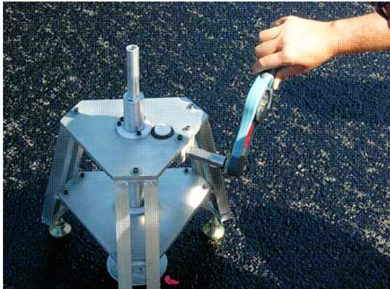
Figura 2.15: Dispositivo UTEP y llave de torque.
