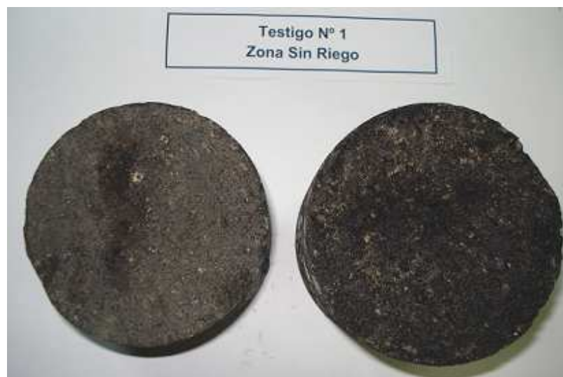
Figura 4.7: Testigo de zona sin riego y espesor de capa superficial 8 cm.
