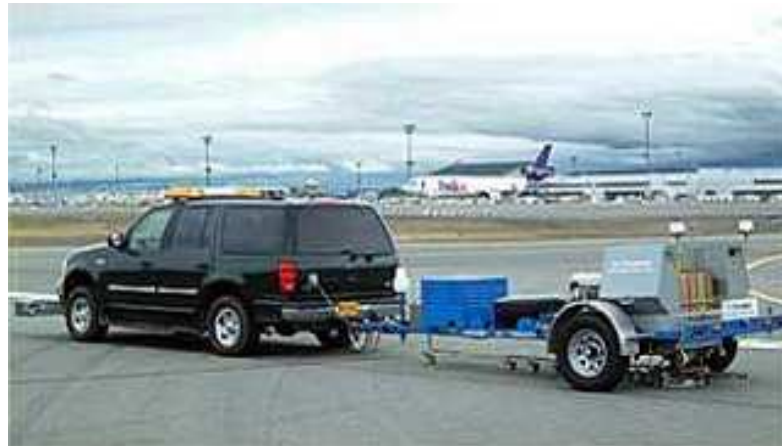
Figura 2.20: Transporte de aparato FWD
