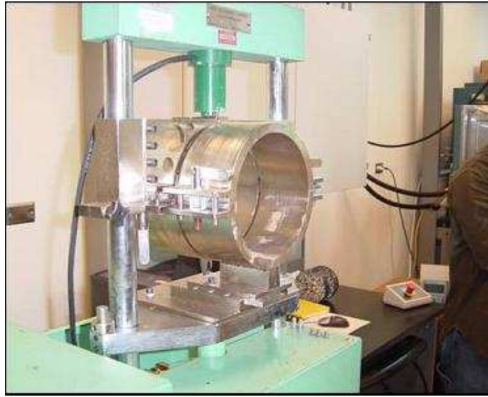
Figura 2.12: Dispositivo de Corte utilizado en el Florida Department of Transportation (FDOT)
