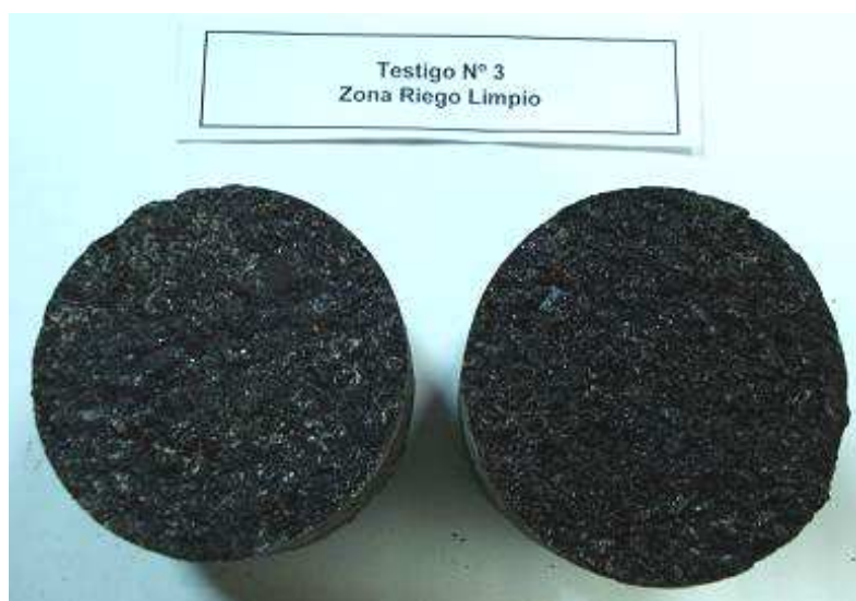
Figura 4.9: Testigo de zona con riego limpio y 8 cm de espesor de capa superficial
