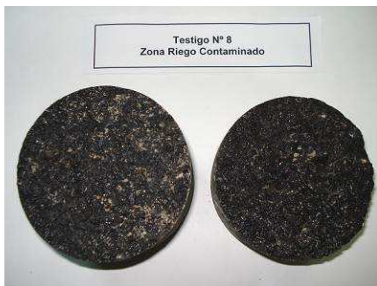
Figura 4.10: Testigo de zona con riego contaminado y 5 cm de espesor de capa superficial
