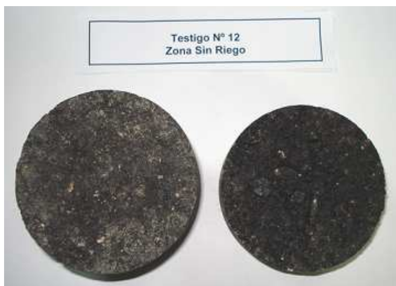
Figura 4.8: Testigo de zona sin riego y 5 cm de espesor de capa superficial.
