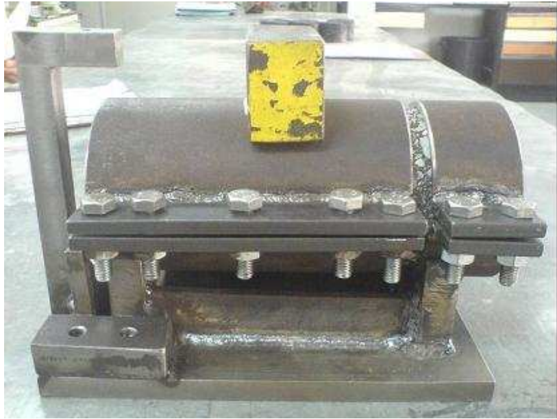
Figura 3.18: Dispositivo de corte LCB y testigo
