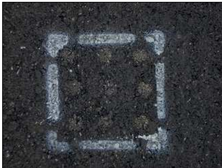
Figura 3.16: Área de impacto luego de ensayo de índice de rebote
