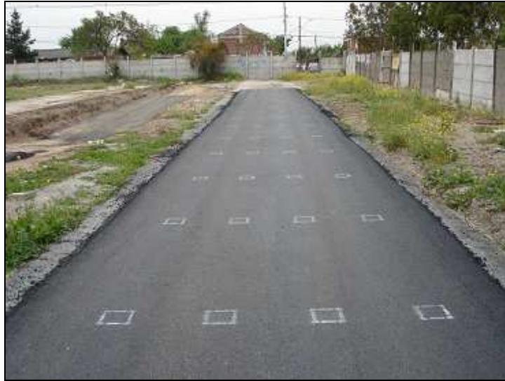
Figura 3.15: Implementación de malla de puntos
