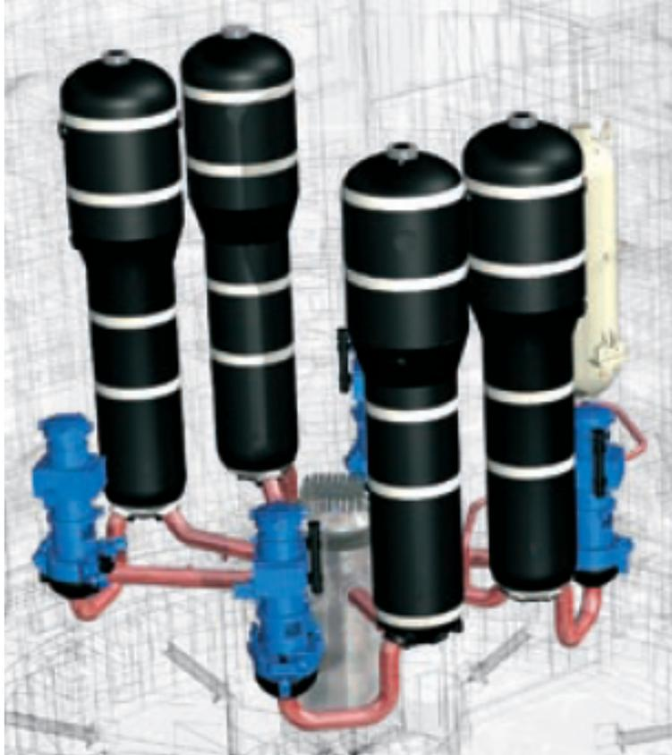
Figura 6.14: Esquema del sistema de refrigeración del reactor US-EPR de Areva.
