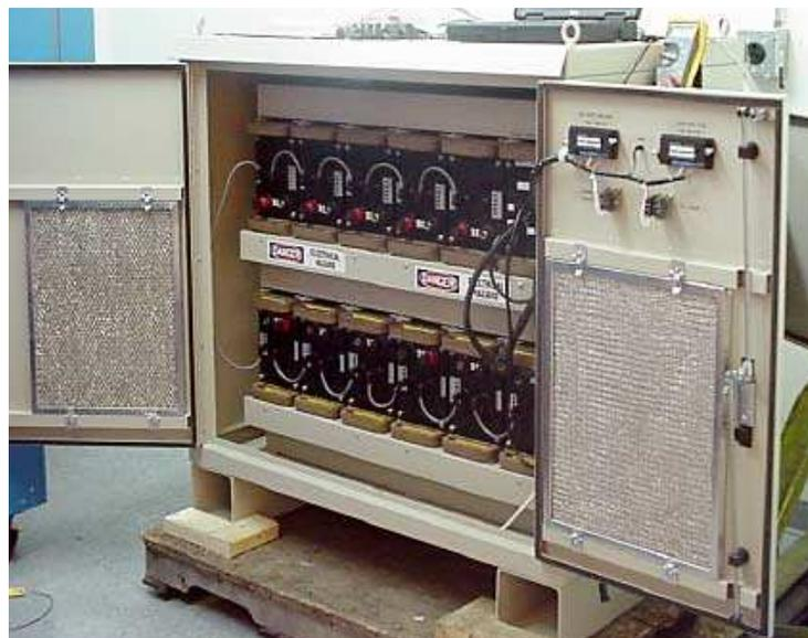
Figura 34. UPS basada en baterías de Li-Ion. Fuente: SAFT America.
