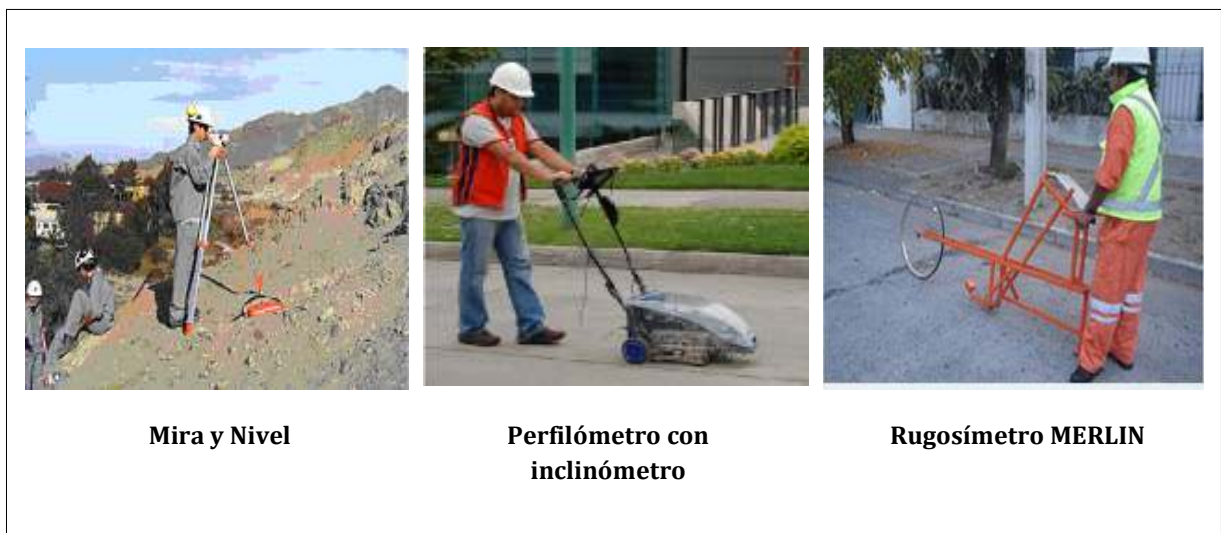
Fig. 2.13. Equipos de Bajo Rendimiento para la medición del IRI
