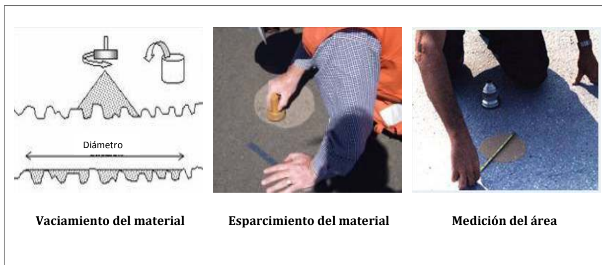
Fig. 2.16. Ensayo del Círculo de Arena
