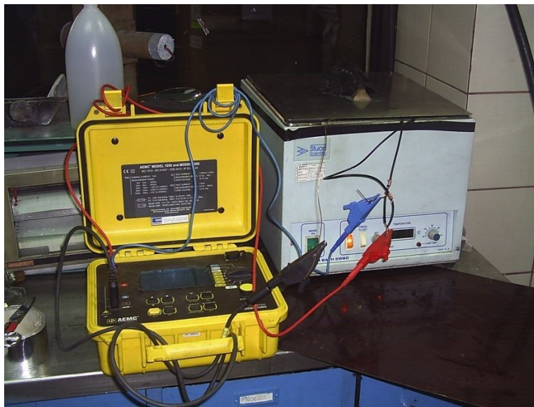
Figura 3.32: "Conductor dentro del horno y conexiones para medir el valor de la resistencia de aislación"
