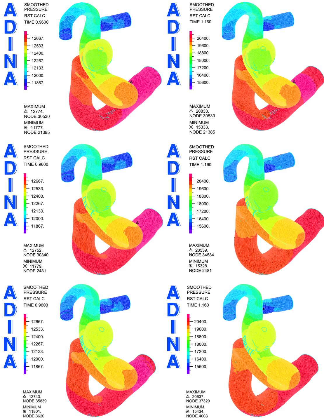
Figura 5.6: Distribución de presión en las geometrías completas para la diástole (figuras izquierda. 0.96 [s]) y la sístole (figura derecha. 1.16 [s]). Arriba: Simulación Sin Stent, Medio: Simulación Stent 4 Anillos, Abajo: Simulación Stent 8 anillos
