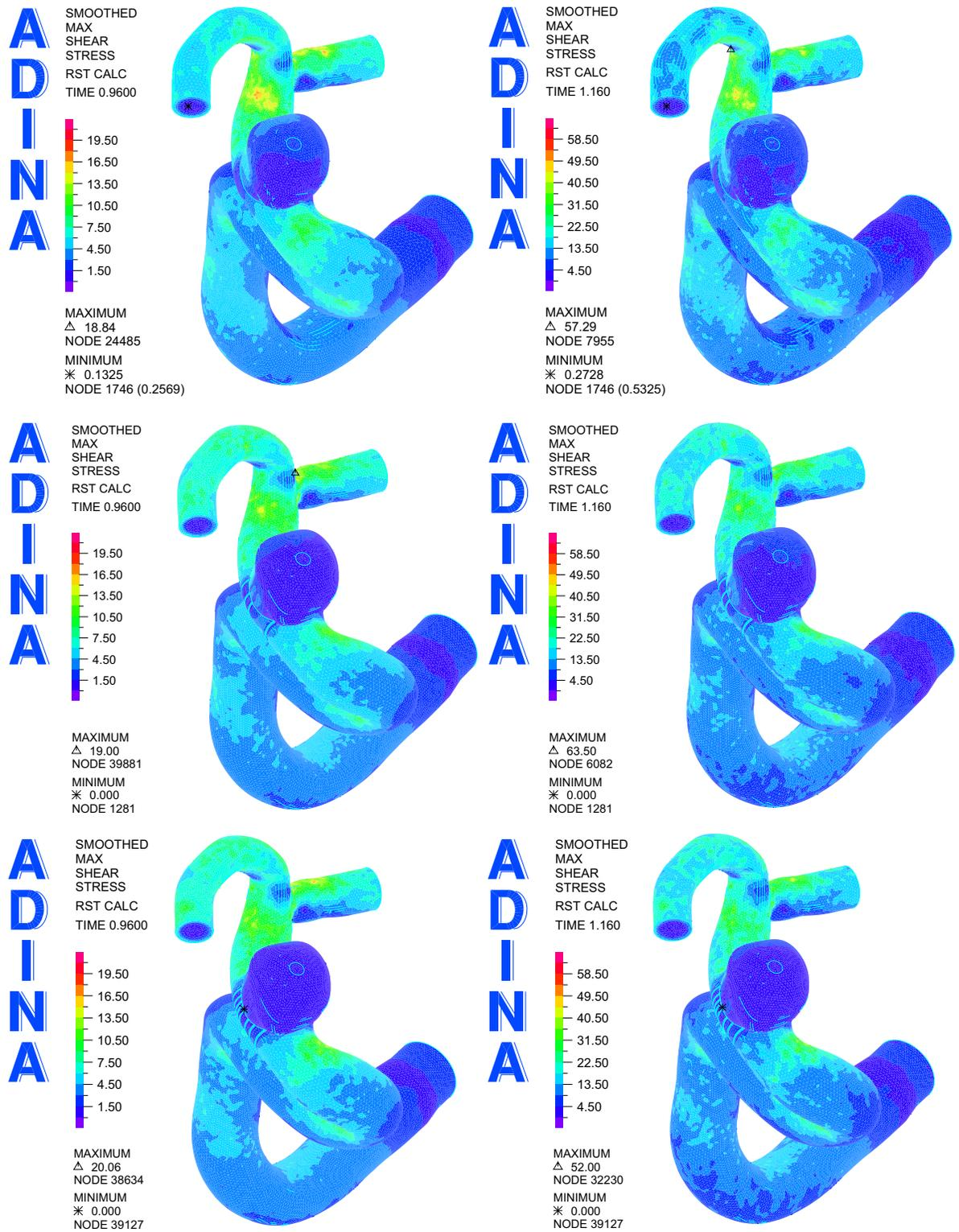
Figura 5.7: Distribución del esfuerzo de corte en las geometrías completas para la diástole (figuras izquierda. 0.96 [s]) y la sístole (figuras derecha. 1.16 [s]). Arriba: Simulación Sin Stent, Medio: Simulación Stent 4 Anillos, Abajo: Simulación Stent 8 anillos
