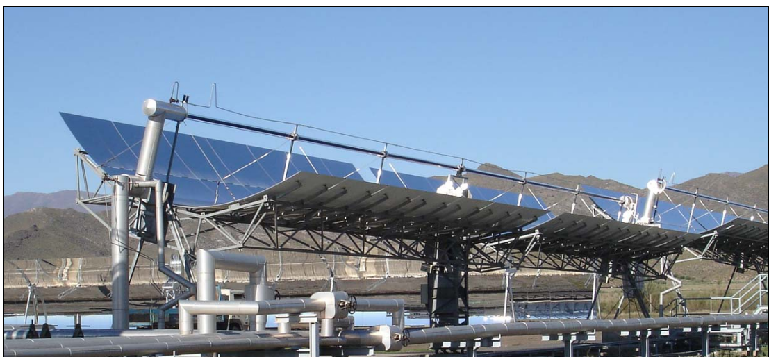
Figura 2.3: Concentradores parabólicos en Plataforma Solar de Almería, España [6]
