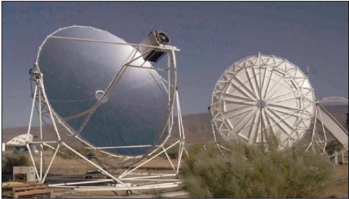
Figura 2.5: Concentrador Parabólico EuroDish con motor-generador Stirling, Almería, España [8]
