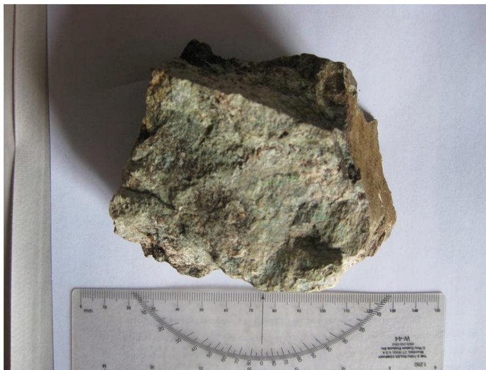
Foto 14. Muestra de brecha ígnea-hidrotermal con alteración potásica. Se puede observar el color rosado, característico del feldespato potásico (Coordenadas UTM 6261133 - N 313287 E).
