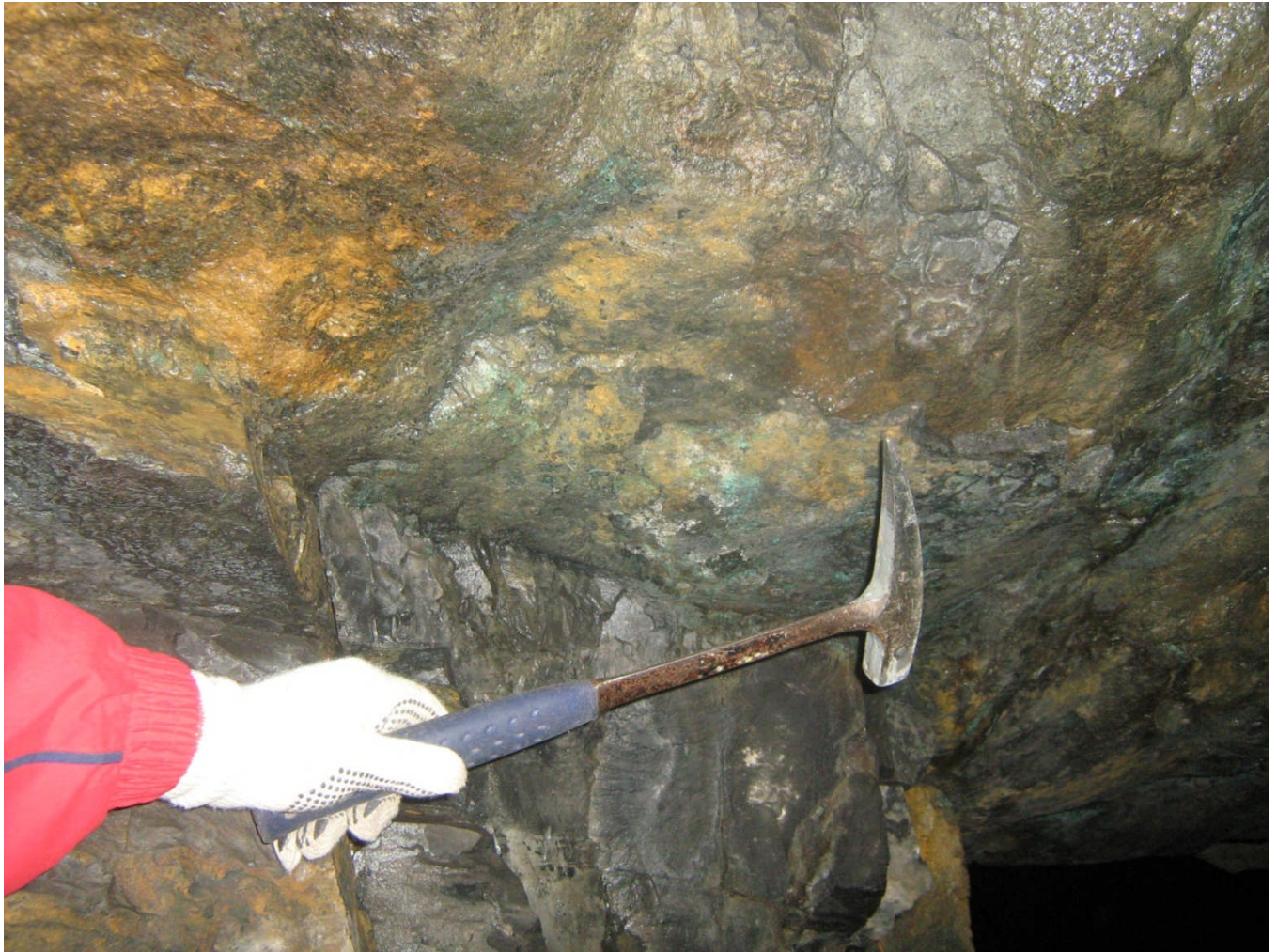
Foto 20. Contacto entre Brechas Ígneo-Hidrotermales (arriba) y Calizas (abajo). Labores mineras en calizas mineralizadas. Coordenadas UTM 6261699N, 313135E
