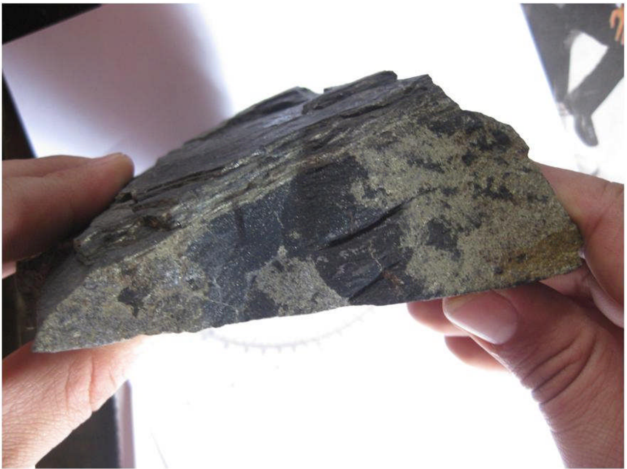
Foto 8. Caliza mineralizada en forma de vetillas (calcopirita, pirita) y diseminado. Coordenadas UTM 6261699N, 313135E
