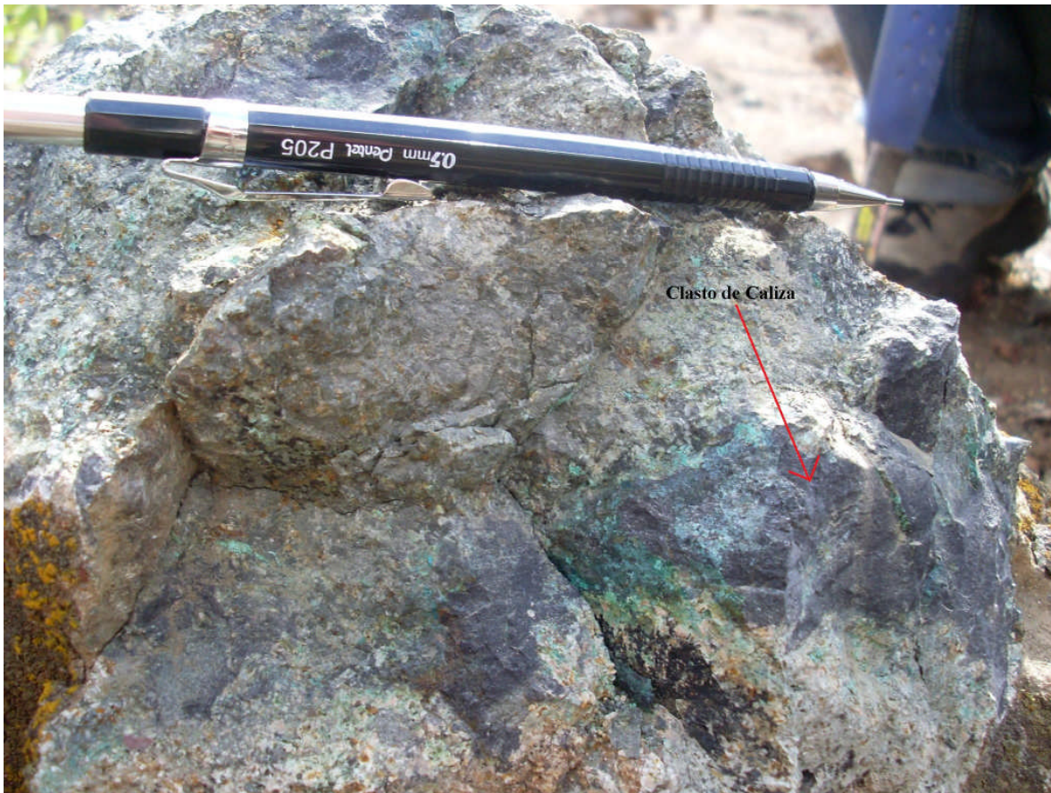
Foto 5. Brecha con matriz ígnea y clasto de caliza (Coordenadas 6261790N, 313164E).
