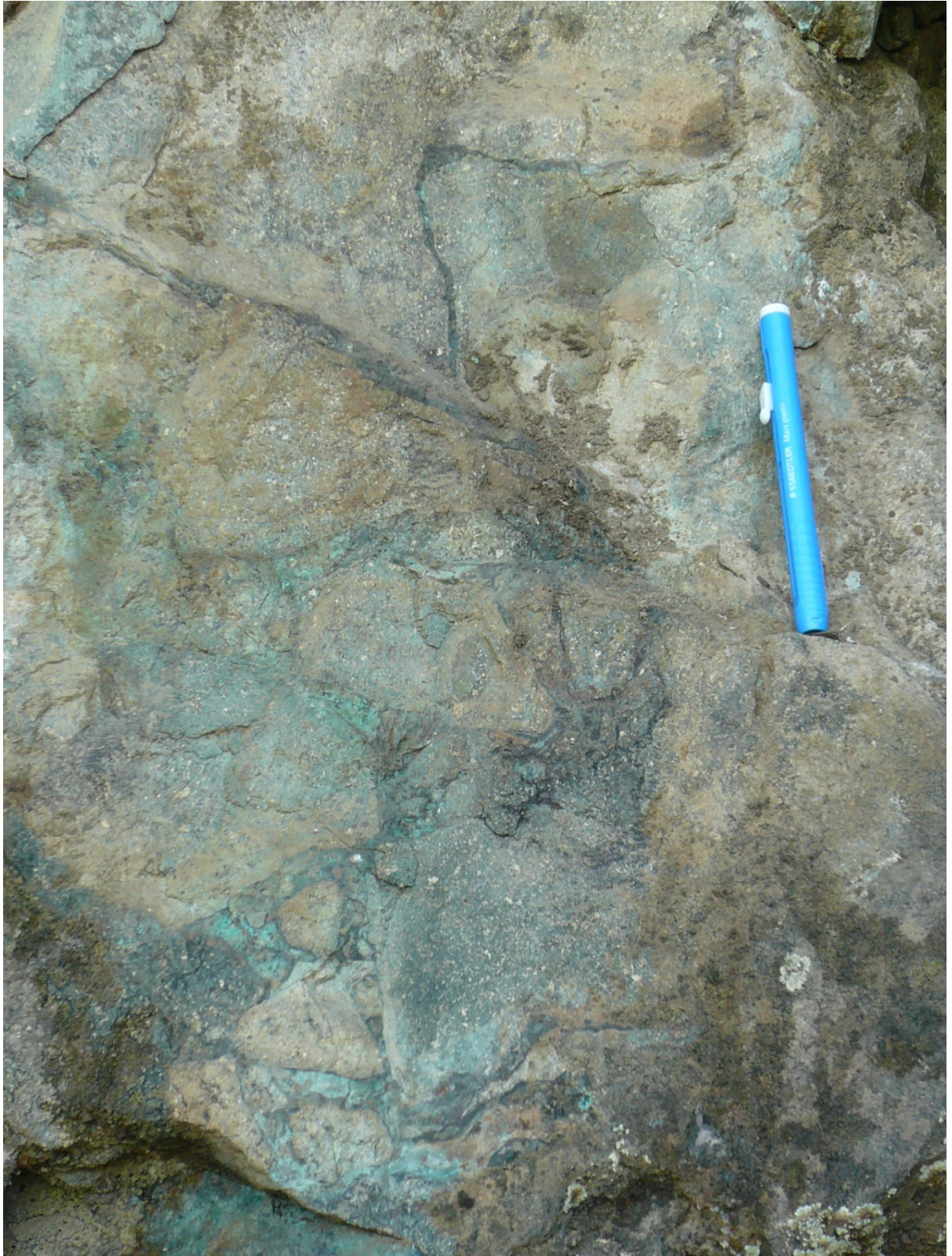
Foto 4. Brecha con matriz hidrotermal de la Chimenea Central (6261141N, 313309E).
