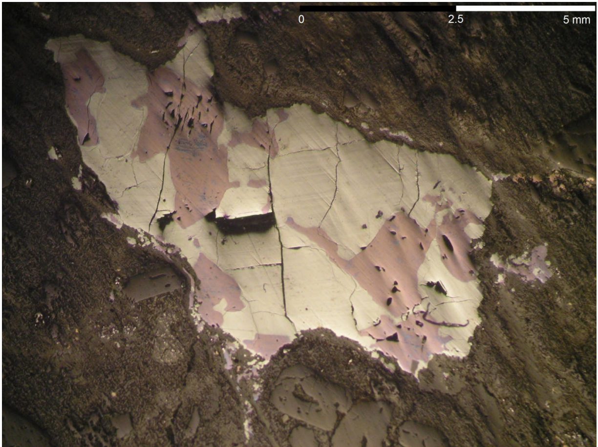
Foto 18. Corte pulido muestra de brecha ígneo-hidrotermal (MCO-08). Se pueden observar minerales de Digenita, Bornita y Calcosina.
