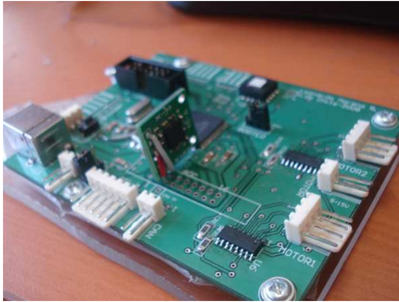
Figura 3.8: Placa de control y sensores.
