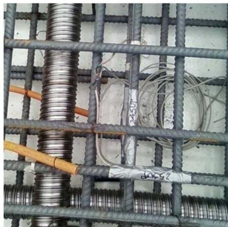
**Figura 3.16: *Strain gauges* instalados en la malla superior de la losa**
