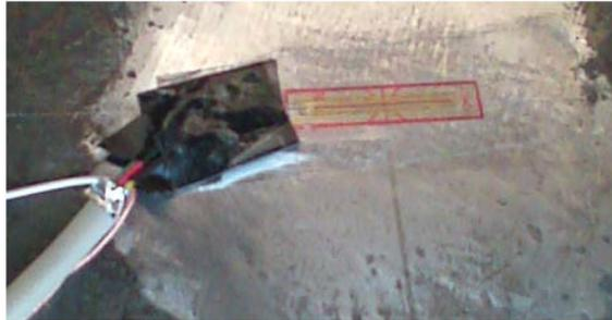
**Figura 3.2: Strain gauge instalado en el perfil de acero**
