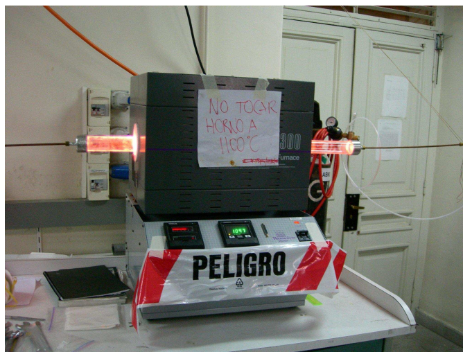
Figura 3.5: Horno High temperature tube furnace F59300 de marca Thermolyne.
