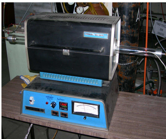
Figura 3.6: Horno para el tratamiento térmico de los contactos metálicos.
