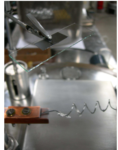
Figura 3.3: Montaje de la Oblea de silicio en evaporador.
