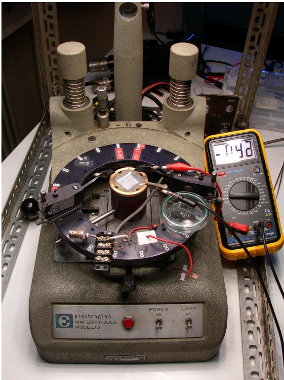
Figura 4.26: Equipo para medir corriente en la celda.
