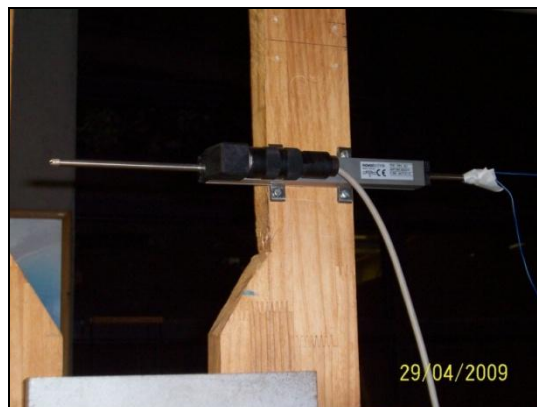
Figura 4.15. Potenciómetro utilizado para medición de desplazamientos de techo.
