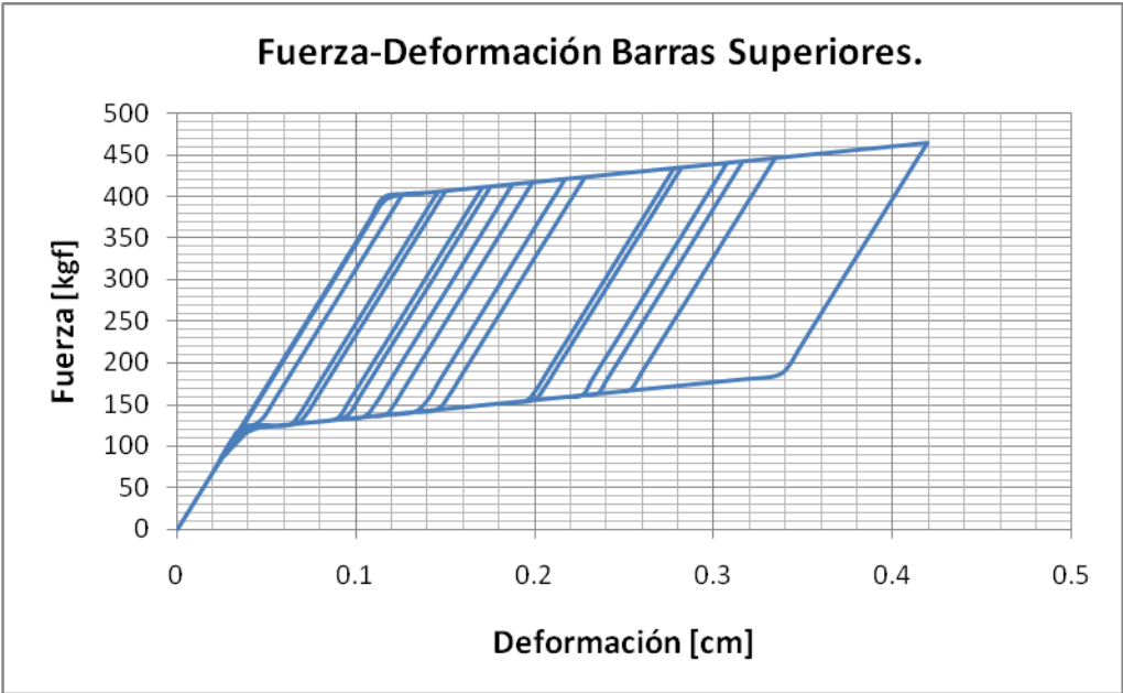
Figura 3.6. Fuerza Axial v/s Deformación de las Barras Superiores de la Conexión 1.
