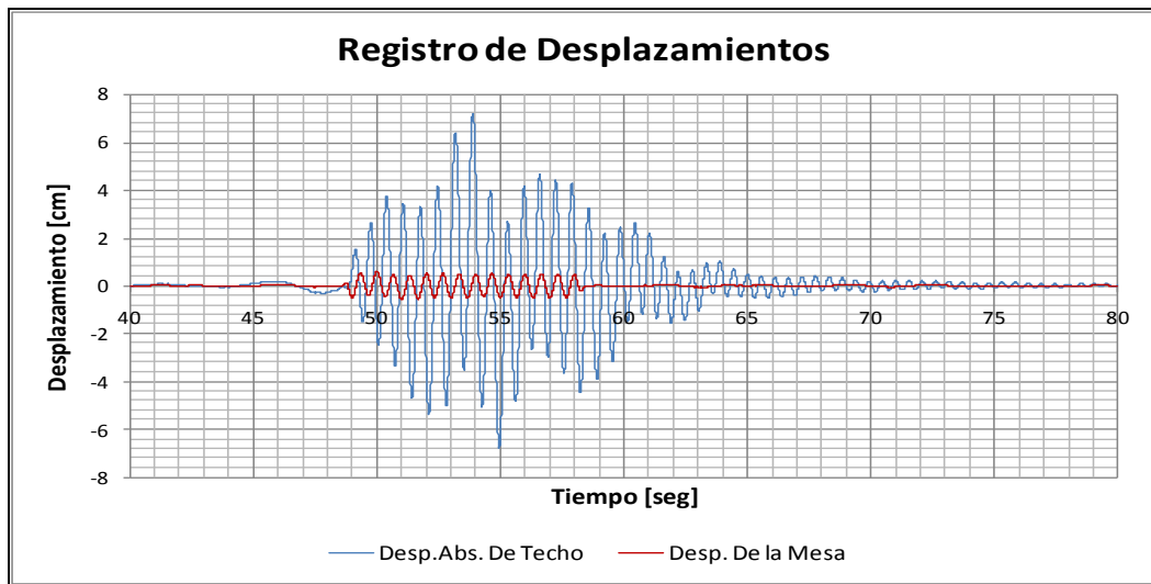
Figura 5.39. Registro de Desplazamientos.
