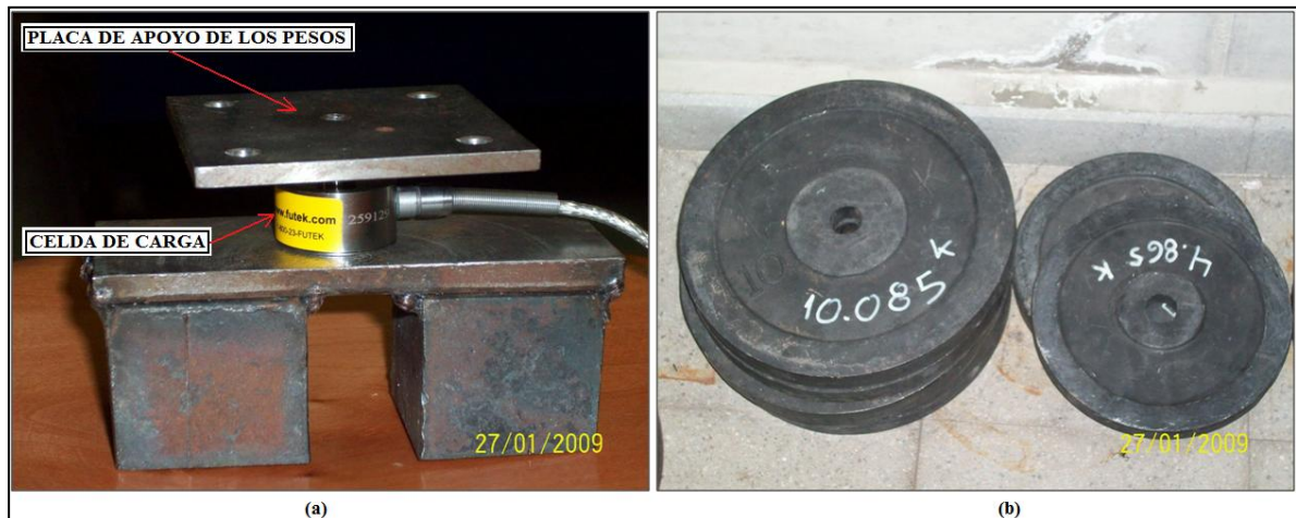
Figura 4.16. (a): Montaje para calibración de celdas de carga. (b): Pesos utilizados para la calibración de las celdas.
