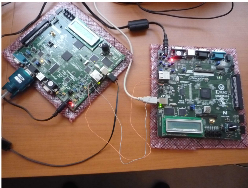
Figura 3.5: Disposición de las plataformas FPGA para realizar las pruebas de funcionamiento.
