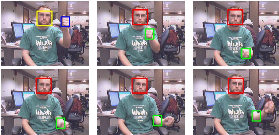
Figura 5.3: Ejemplo de fallo del tracking. El usuario describe un cero, pero el tracking se distrae con el brazo.
