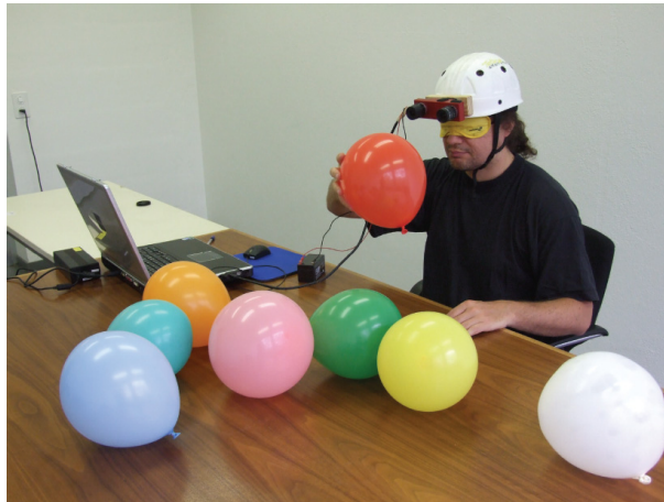
Figura 17: Usuario utilizando See CoLoR para detectar colores a través del sonido [12].
