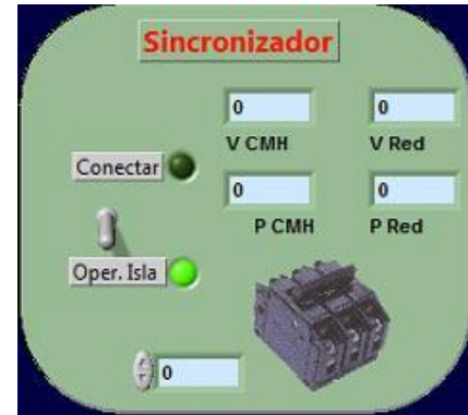
Figura 7.16: Control modo de operación CMH
