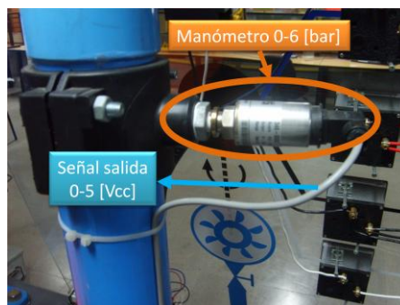
Figura 7.2: Conexión del manómetro a la tubería CMH.
