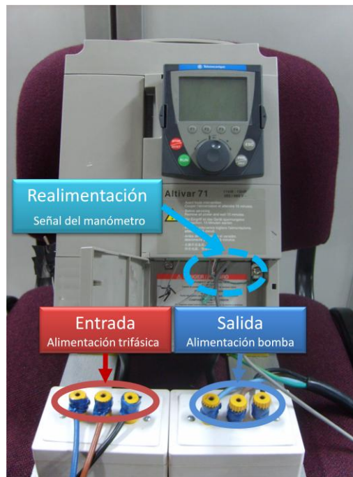
Figura 7.3: Variador de frecuencia Altivar 71.
