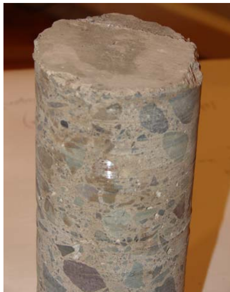
Fig. 7.1.1.1.1.7 Detalle de Testigo N°2, Testigo Invertido. No se Aprecian Fisuras.
