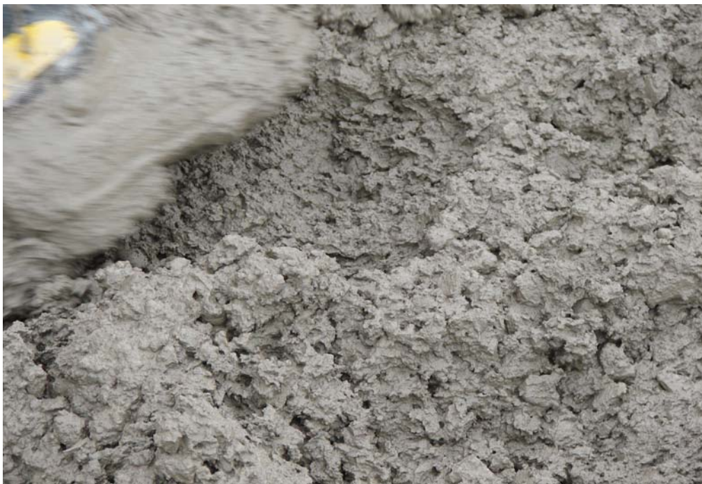
Fig. 6.1.3.3.4 Consistencia del Hormigón al Salir de la Tubería, antes de ser Vibrada.
