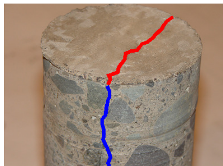
Fig. 7.1.1.1.2.6B Detalle de Testigo N°6, Vista Invertida, Línea Roja Describe Trayectoria de Fisura en la Superficie, Línea Azul Describe Trayectoria Fisura al Interior del Testigo.
