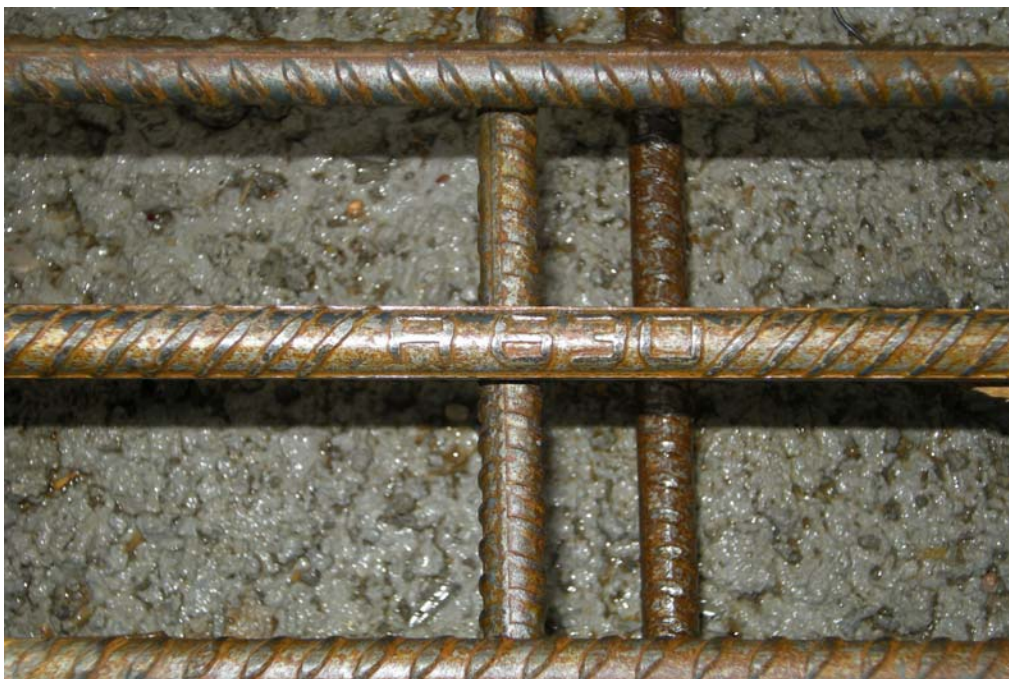
Fig. 6.1.3.2.8 Detalle Marca Acero A630 (A63-42H).
