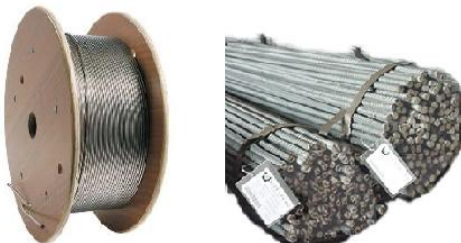
Figura 7.1 y 7.2: Acero en rollo y en barra; Fuente: cap.cl, Junio 2010.
