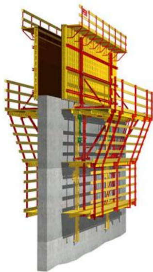
Figura 6.5: Moldaje autotrepantes; Fuente: Peri, Mayo 2010.
