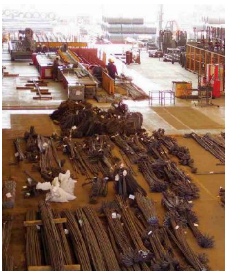
Figura 7.3: Fabricación industrial de armadura; Fuente: armacero.cl, Junio 2010.
