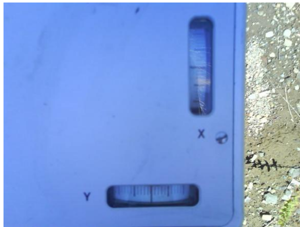
Fotografía 4.2 Niveles tubulares indicadores de la nivelación.
