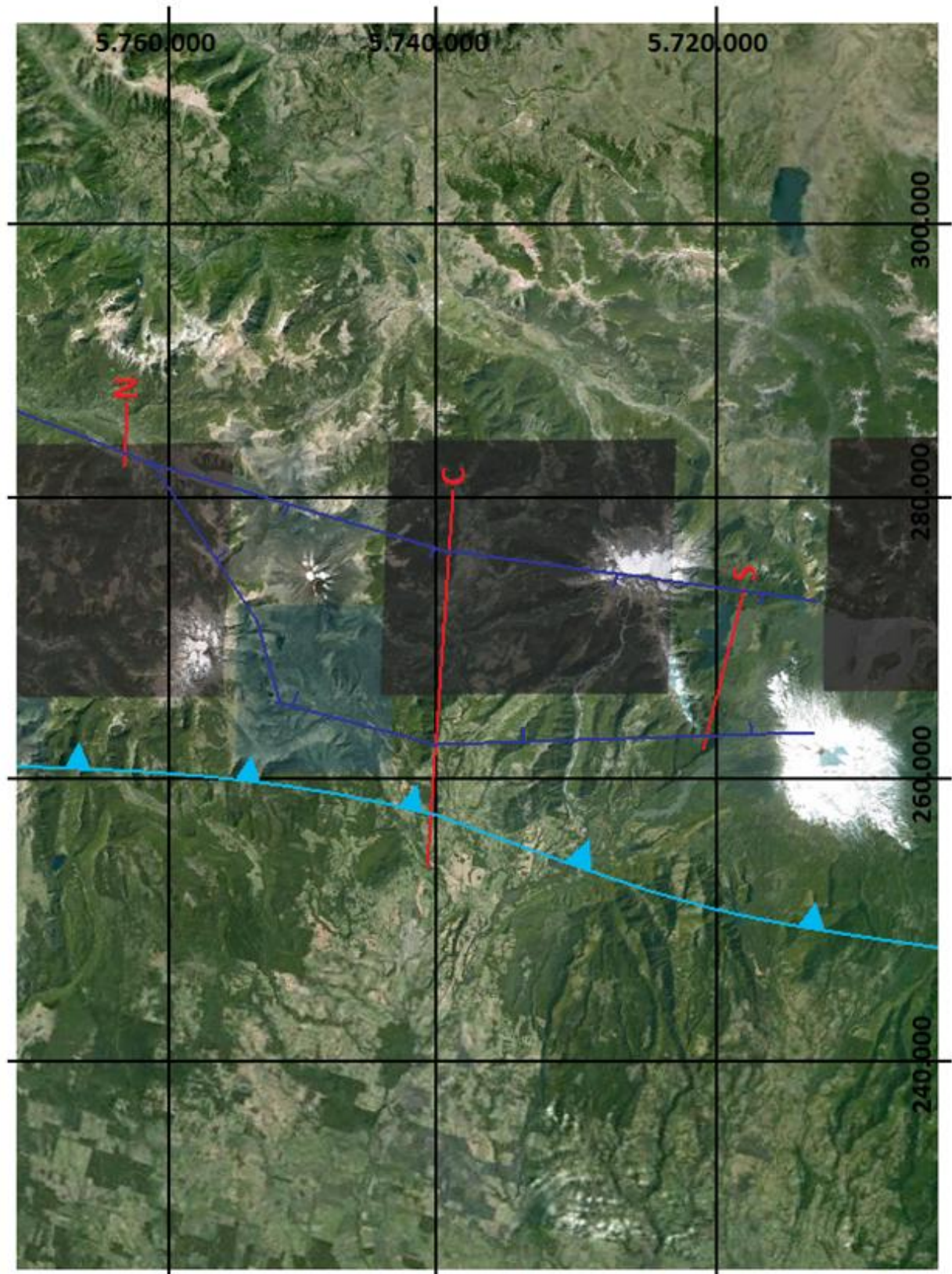
Figura 5.11 Modelo final de la zona en estudio. Se señalan la ubicación de los perfiles gravimétricos. Es interesante notar cómo tanto los volcanes Llaima como Sierra Nevada coinciden con los bordes de esta configuración. Proyección UTM 19 S. Elipsoide WGS84.
