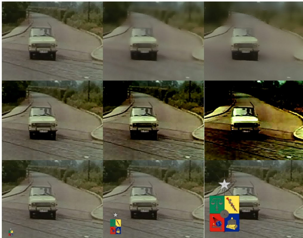
Figura 2.3: Tres transformaciones para un mismo frame de un video, pero con distintos parámetros. De arriba hacia abajo: blur , contraste y Pattern . De izquierda a derecha: parámetros suaves, medios y agresivos.
