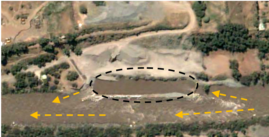
Figura 2.8 Extracción de sedimentos en el río Maipo, desde banco arenoso (“Google Earth”)
