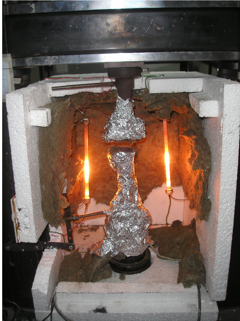
Figura 4.3: Sistema de Calentamiento funcionando
