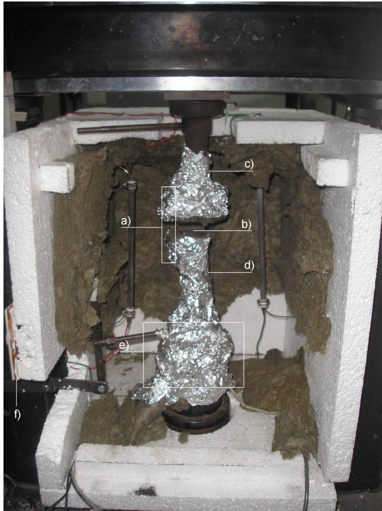
Figura 4.5: Montaje de los Ensayos a)Extensómetro con aislación. b)Termocupla tipo K y espacio entre punzones. c)Punzón Superior. d)Punzón Inferior e)Celda de Carga aislada. f)Dimmer
