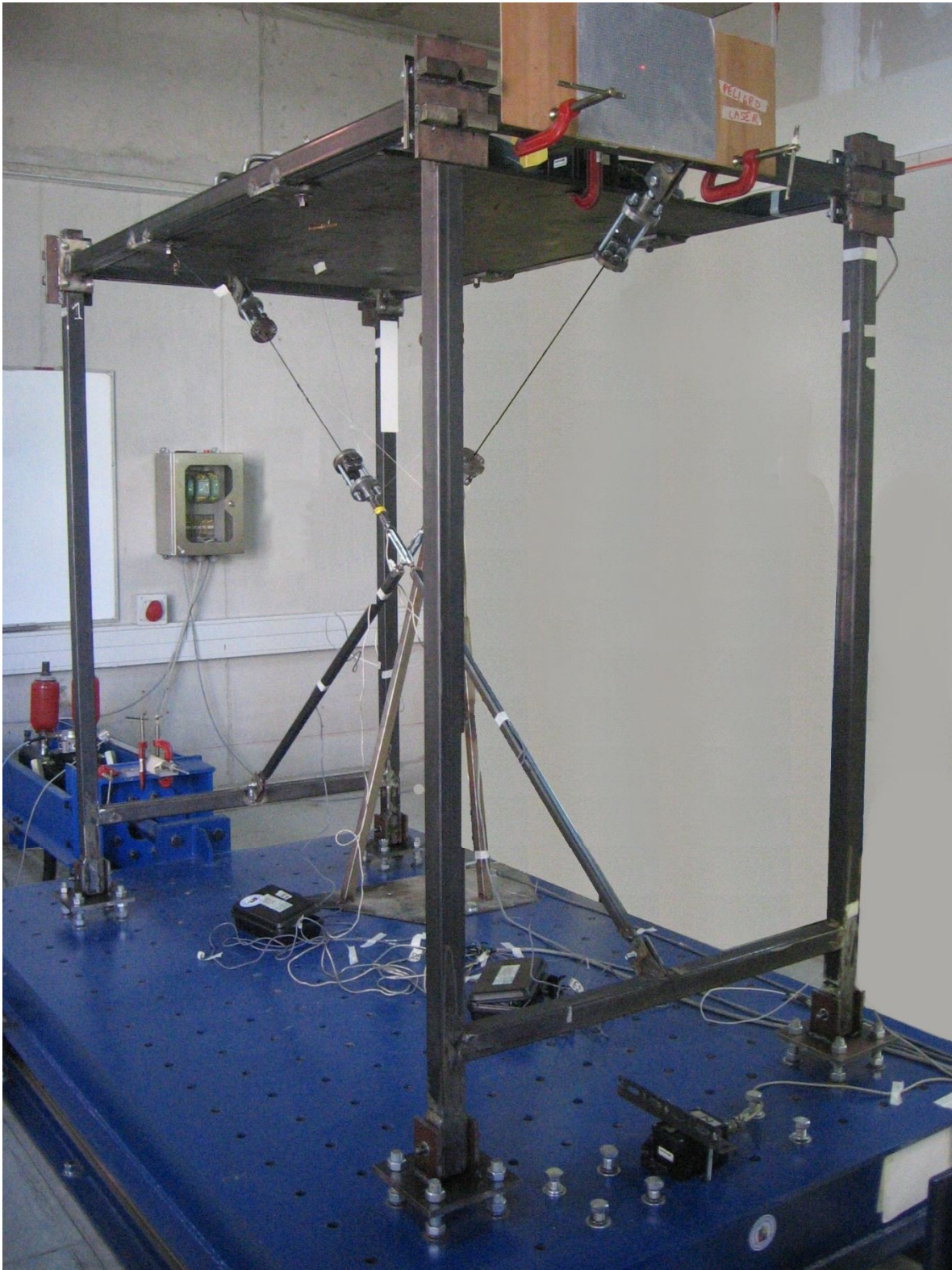
Figura 5.2: Instalación marco arriostrado sobre mesa vibradora
