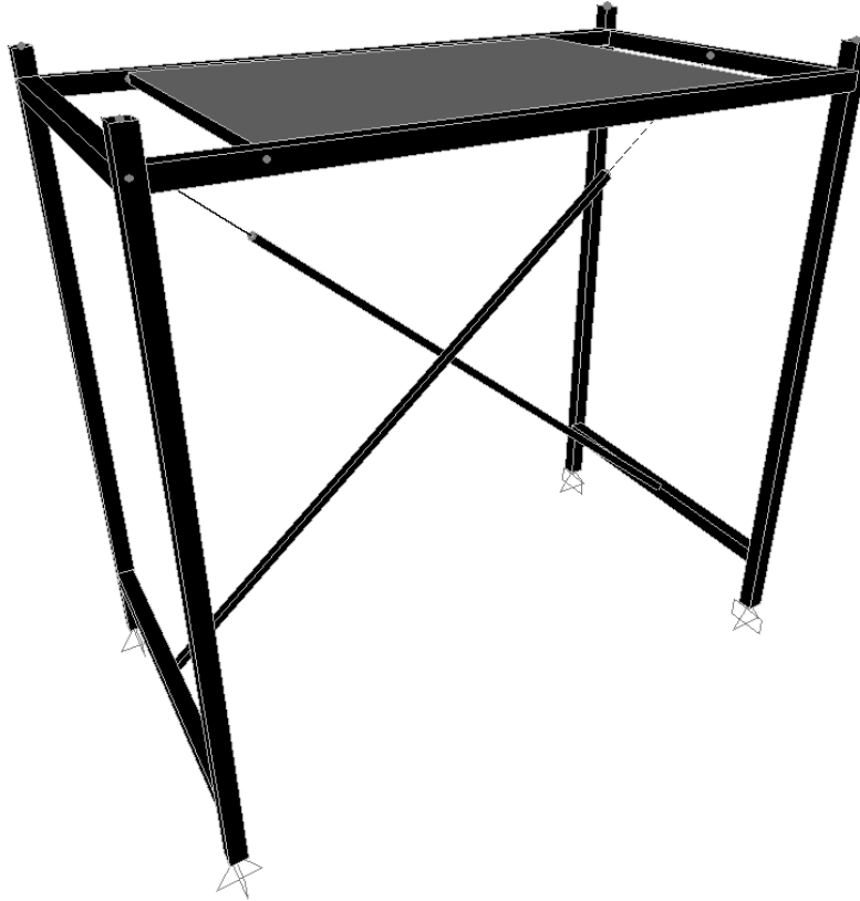
Figura 2.3: Estructura: marco arriostrado
