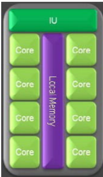
Figura 2.3: Detalle de un Stream Multiprocessor . [11]
