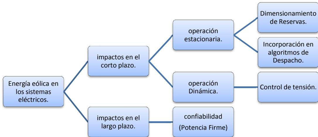
Figura 2.6. Energía Eólica en los sistemas eléctricos.
