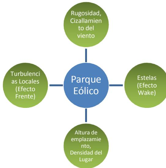
*Figura 3.2. Elementos que afectan el comportamiento del parque eólico.*
