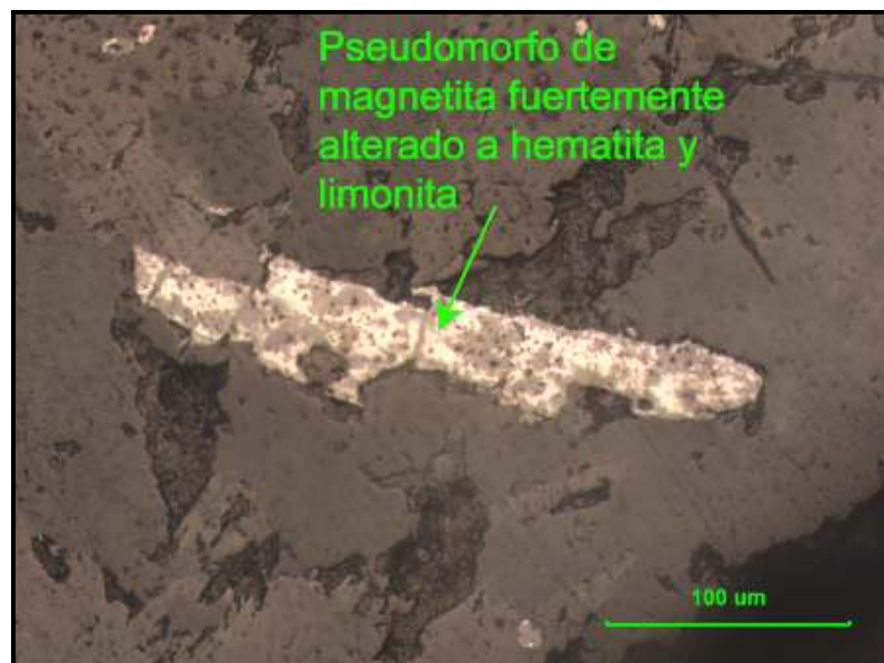
Figura 5.4: Pseudomorfo de magnetita fuertemente alterado a hematita y limonita, muestra TN0722B, nivel de gabros.
