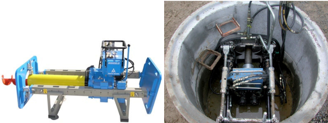
Figura 4-4: Fotografía del taladro direccional (izquierda), fotografía de un taladro direccional en posición (derecha).
