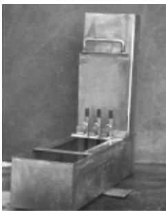
8-3: Ensayo Caja L
