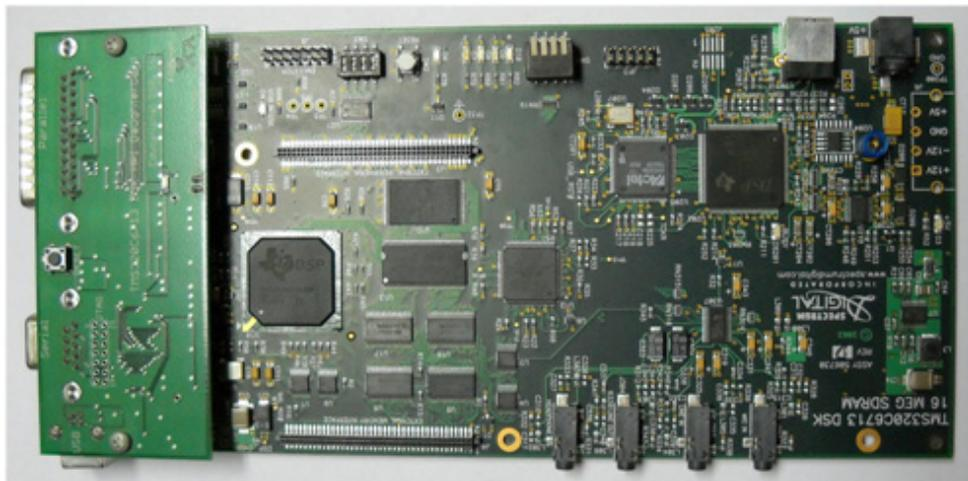
Figura 11: Tarjeta DSK C6713 utilizada en la implementación.
