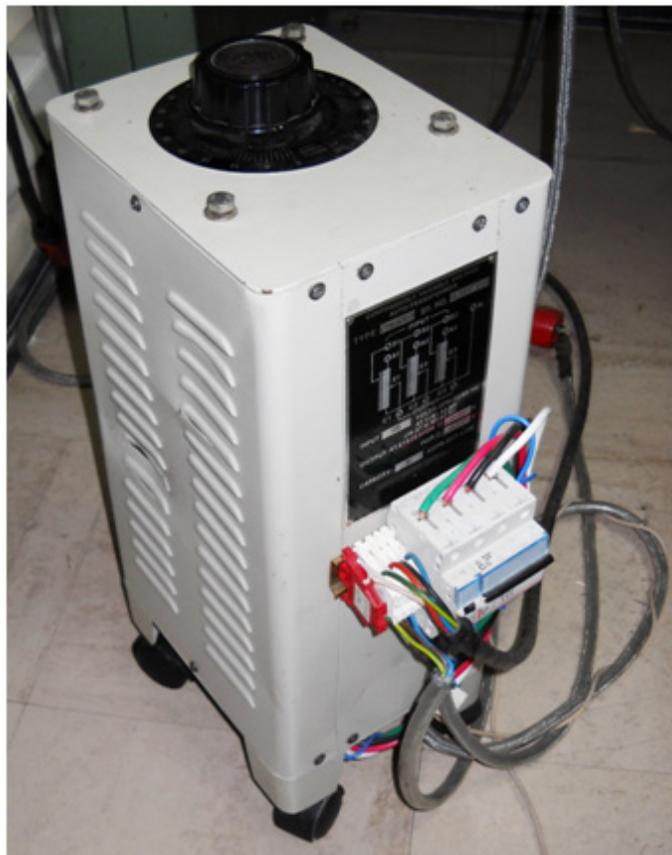
**Figura 8: Autotransformador trifásico utilizado.**
