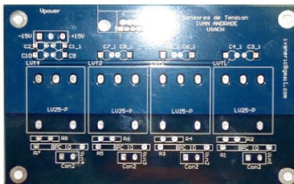
Figura 9: Tarjeta de medición de tensión sin componentes.
