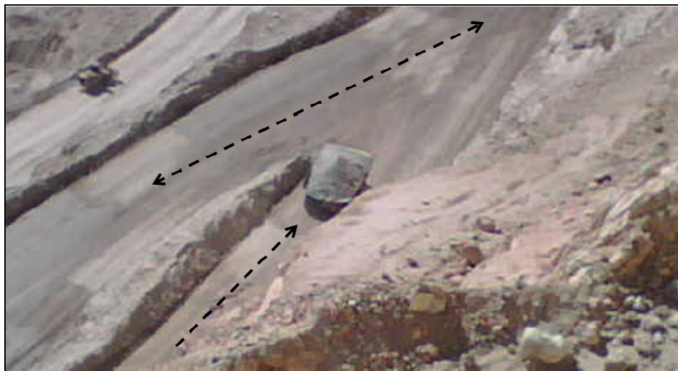
Ilustración 20: Ejemplo de cruce entre rampas
