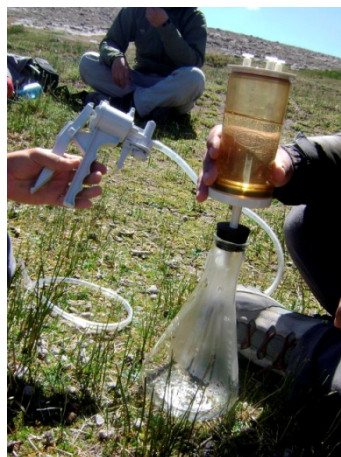
Figura IV-1: Proceso de filtrado del agua.
