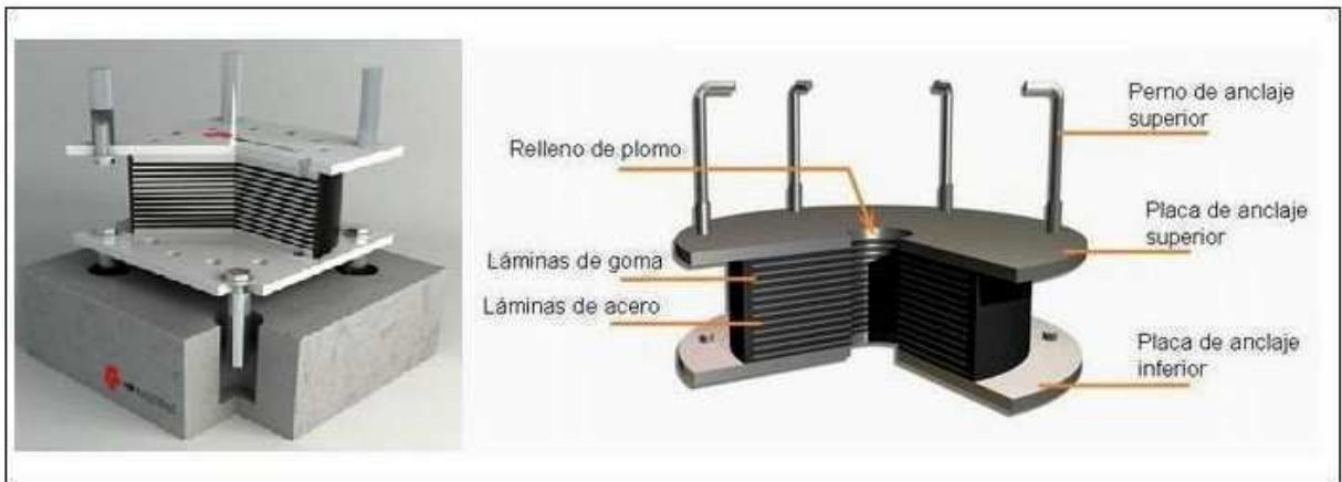
Figura 1.3A. Aislador de base, elastomérico.
