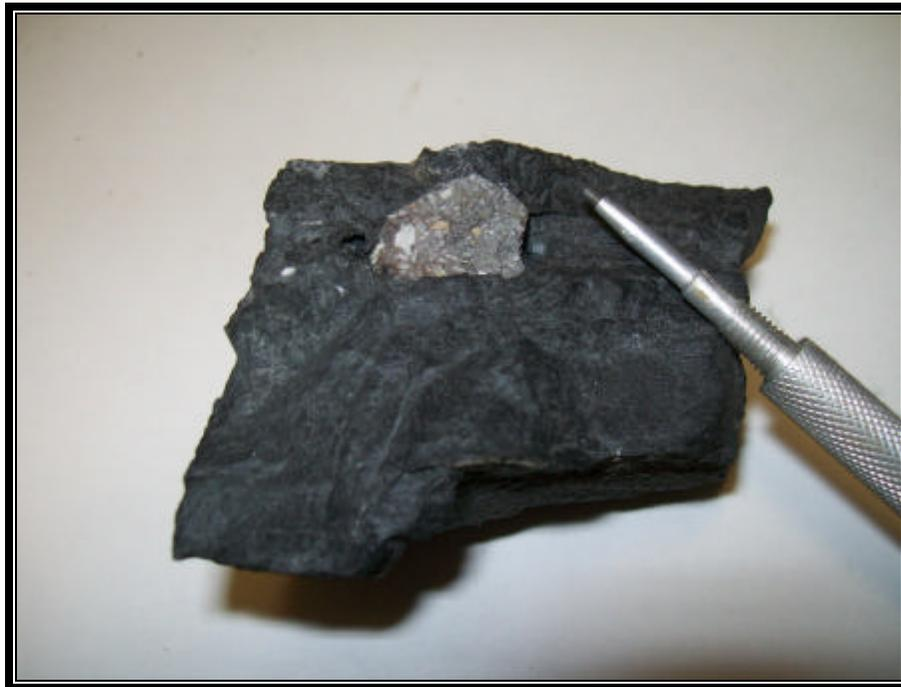
**Fig. 5.1.1.2. Xenolito andesítico sin bordes de reacción, inserto en una colada de lava de un cono de flanco del volcán Lonquimay**
