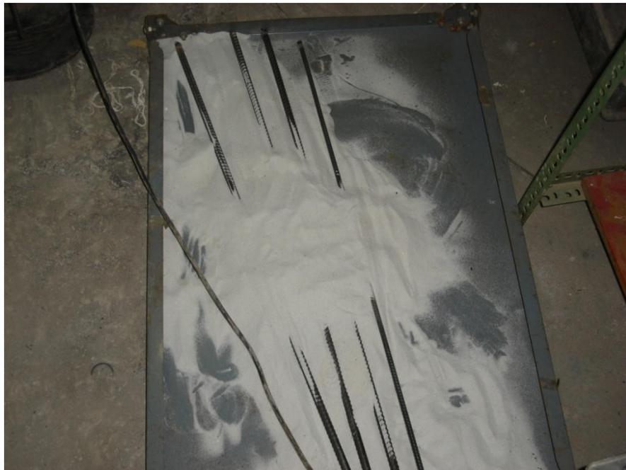
Figura 5.11: Probetas enfriadas en cuarzo
