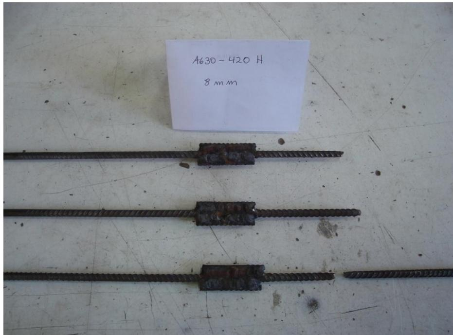
**Figura 5.15: Barras de 8 mm de calidad A630-420H soldadas a tope indirecto con dos barras auxiliares**
