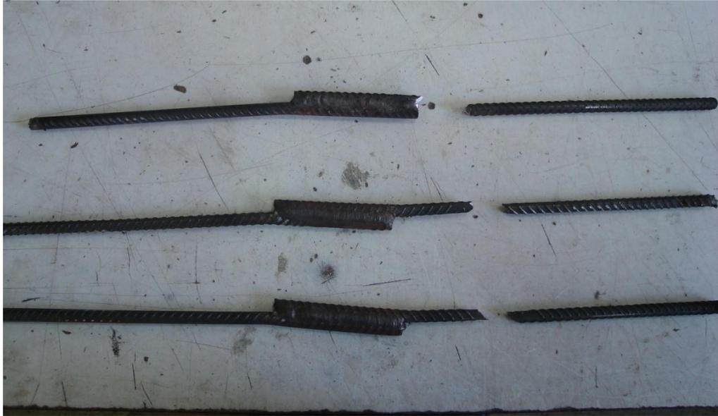
**Figura 5.14: Barras de 10 mm de calidad A630-420H soldadas a solapo**
