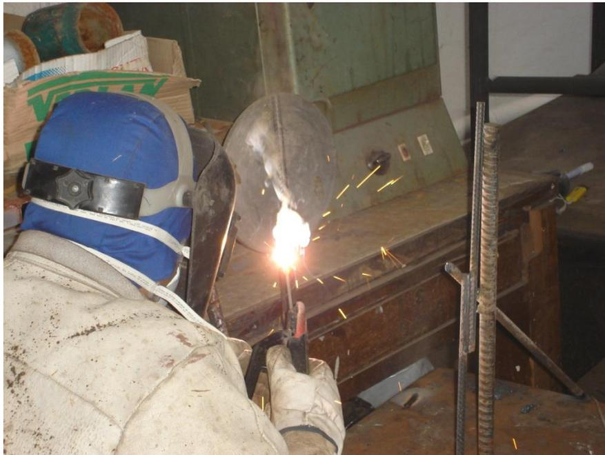
**Figura 2.1: Soldadura al arco eléctrico**
