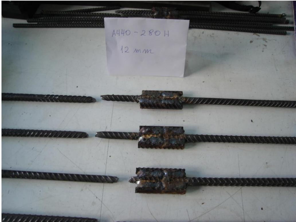
Figura 5.24: Barras de 12 mm de calidad A440-280H soldadas a tope indirecto con dos barras auxiliares
