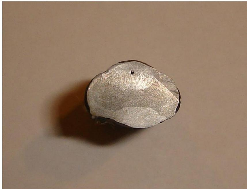
**Figura 5.8: Perfil transversal barra 10 mm y de acero A440-280H**
