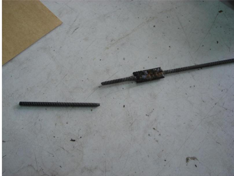
**Figura 5.28: Rotura de probeta soldada de 8 mm de diámetro**
