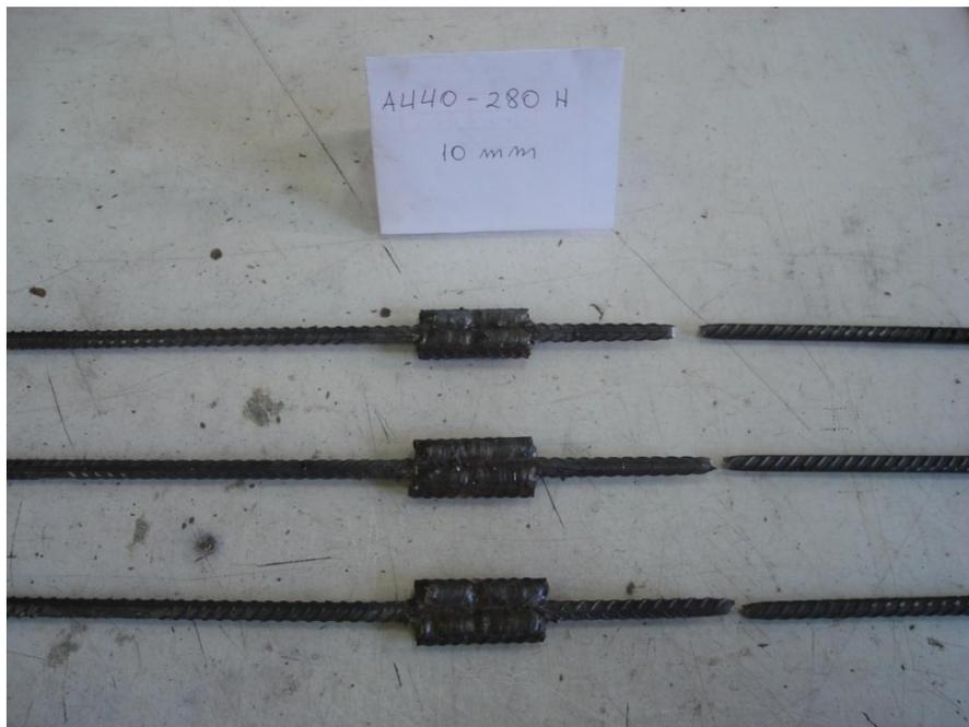
Figura 5.23: Barras de 10 mm de calidad A440-280H soldadas a tope indirecto con dos barras auxiliares
