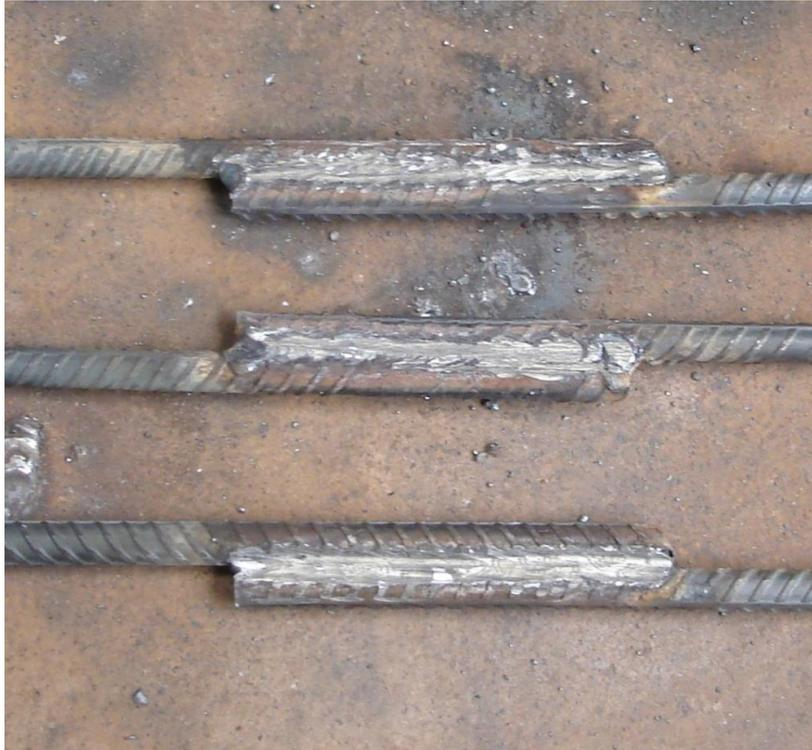
**Figura 5.10: Raíz E6010 en una barra de 10 mm a solapo**
