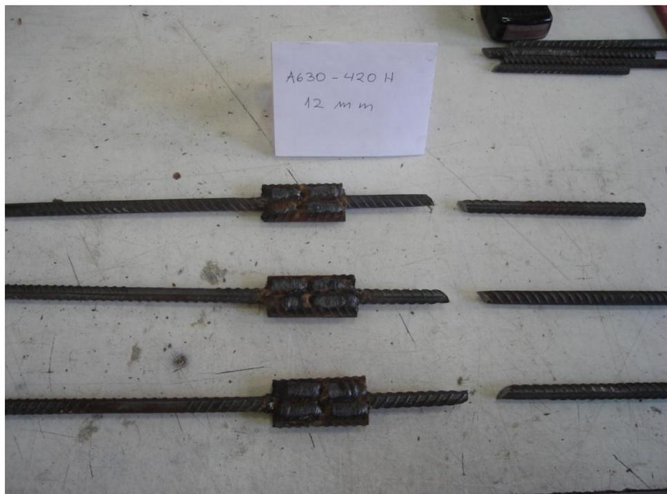
**Figura 5.17: Barras de 8 mm de calidad A630-420H soldadas a tope indirecto con dos barras auxiliares**
