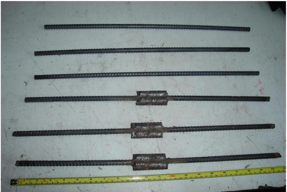
Figura 5.3: Barras soladas a tope indirecto con dos barras de empalme
