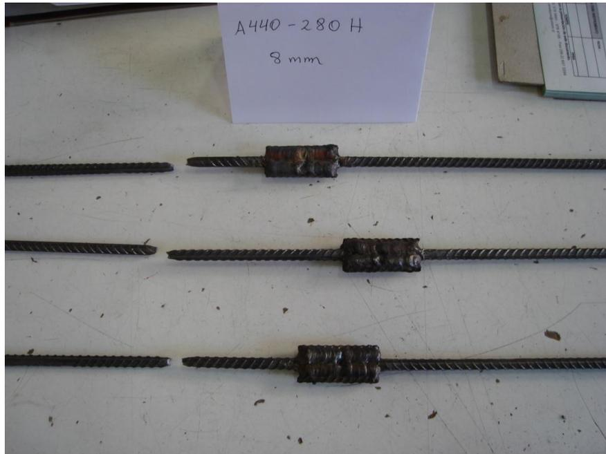
Figura 5.22: Barras de 8 mm de calidad A440-280H soldadas a tope indirecto con dos barras auxiliares.
