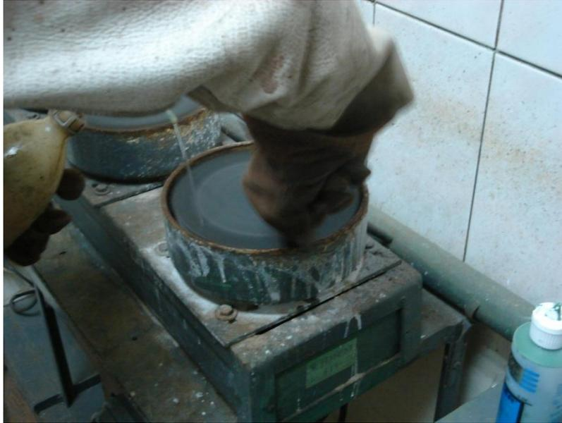
Figura 5.5: Pulido de la barra de acero
