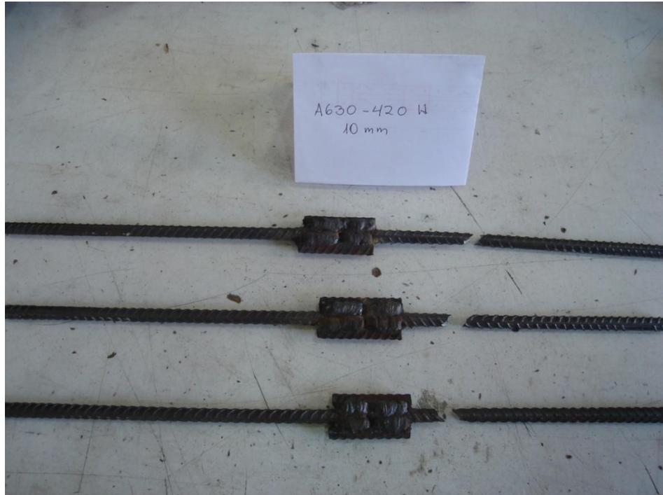
**Figura 5.16: Barras de 10 mm de calidad A630-420H soldadas a tope indirecto con dos barras auxiliares**
