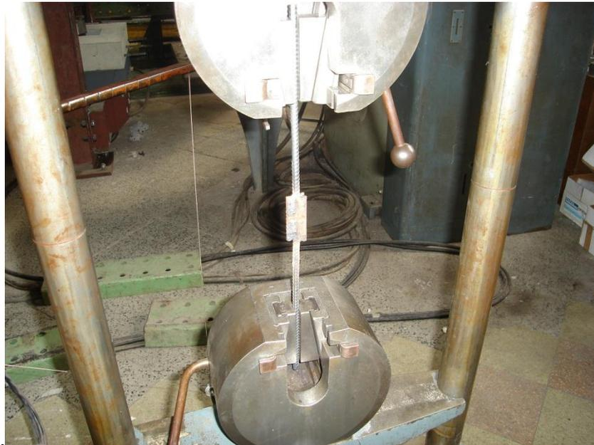
**Figura 4.8: Cuñas entre las que se colocan las probetas**
