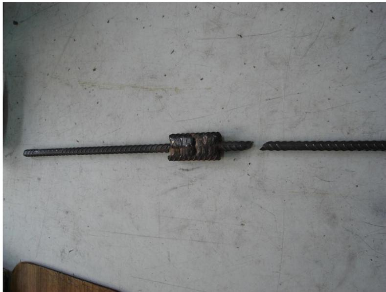
**Figura 5.29: Rotura de probeta soldada de 10 mm de diámetro**
