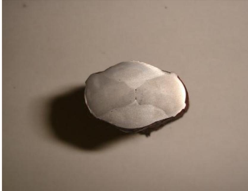
**Figura 5.7: Perfil transversal barra 10 mm y de acero A630-440H**
