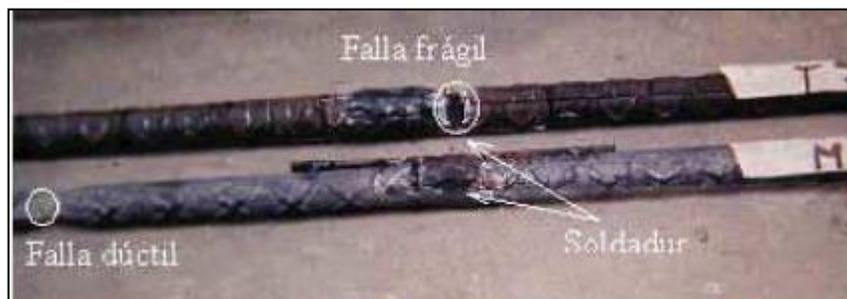
Figura 7.1: Ruptura de barras. (Castilla C, y otros, 2001)
