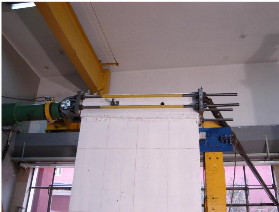
Figura 7.9: conexión del gato hidráulico con el muro.
