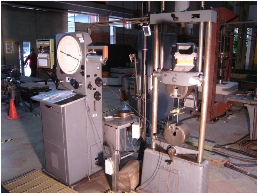
**Figura 4.7: Máquina para ensayos a tracción**
