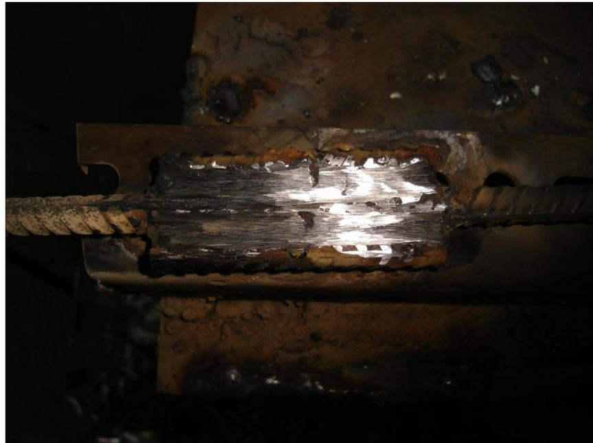
Figura 5.9: Raíz E6010 en una barra de 12 mm a tope indirecto con dos barras de empalme
