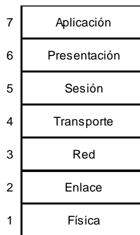
Figura 2.1: Capas del Modelo OSI
