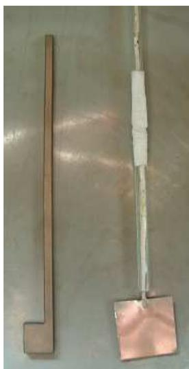
Figura 21: Electrodo utilizados, los metales de izquierda a derecha son Ti y Pt.
