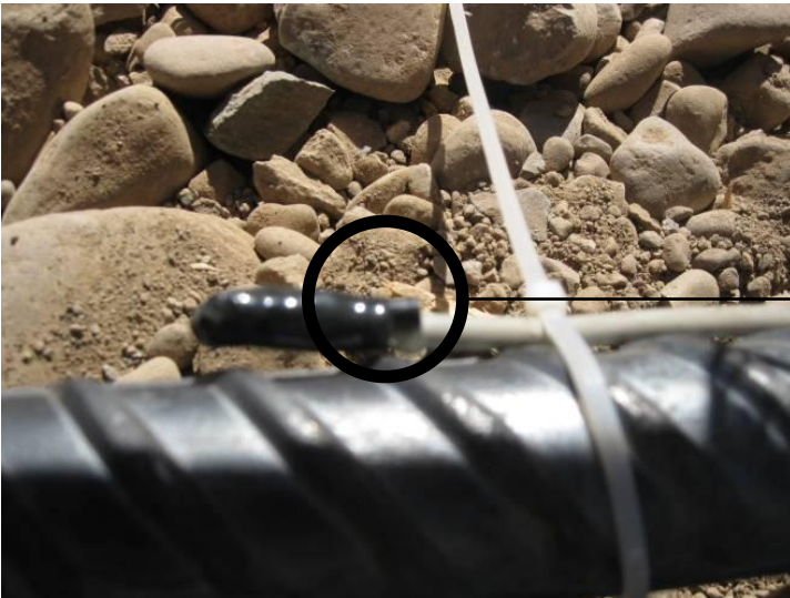
Figura 3.3 LM35DZ, sensores de temperatura fijados a la armadura.
