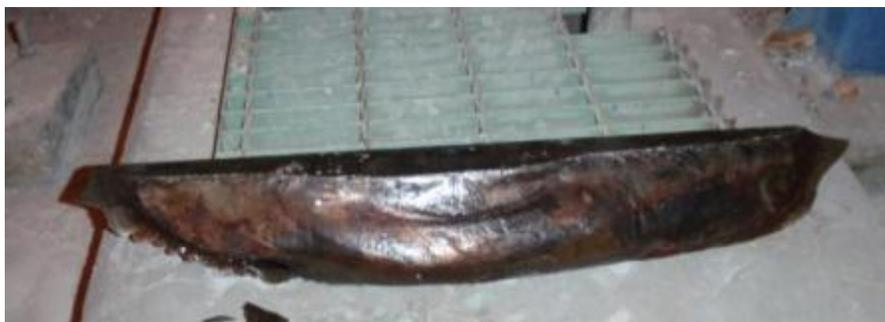
Figura 7-9. Parte de un diente fracturado de un engrane corona-piñón.
