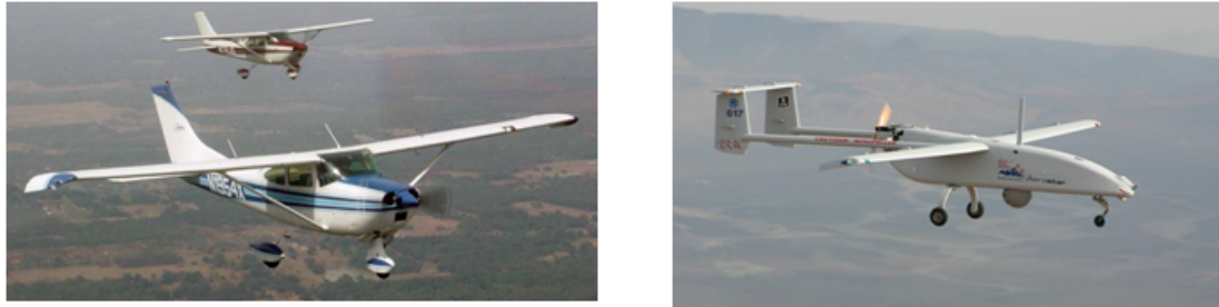
Figura 3.2.1: Configuración tractora y pusher [22]
