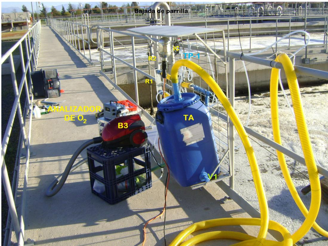
**Figura 30:** Vista lateral del Panel Analizador de off-gas del sistema de medición implementado en la PTAS El Trebal
