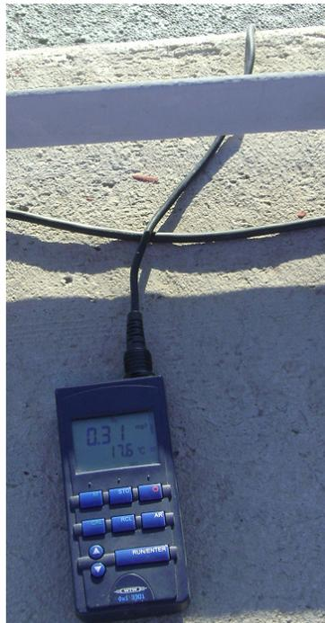
**Figura 27:** Sensor de oxígeno disuelto modelo WTW
