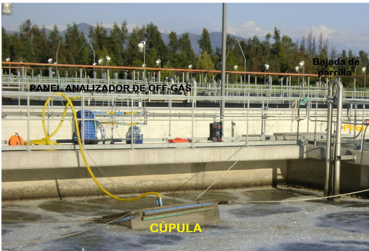
**Figura 31:** Vista general del sistema de medición implementado en la PTAS El Trenal
