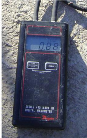
**Figura 25:** Manómetro digital Dwyer 475 FM
