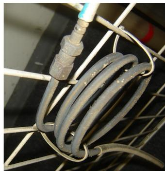
**Figura 15:** Intercambiador de calor (IC)
