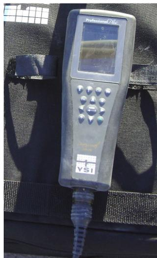
**Figura 26:** Sensor de oxígeno disuelto modelo YSI
