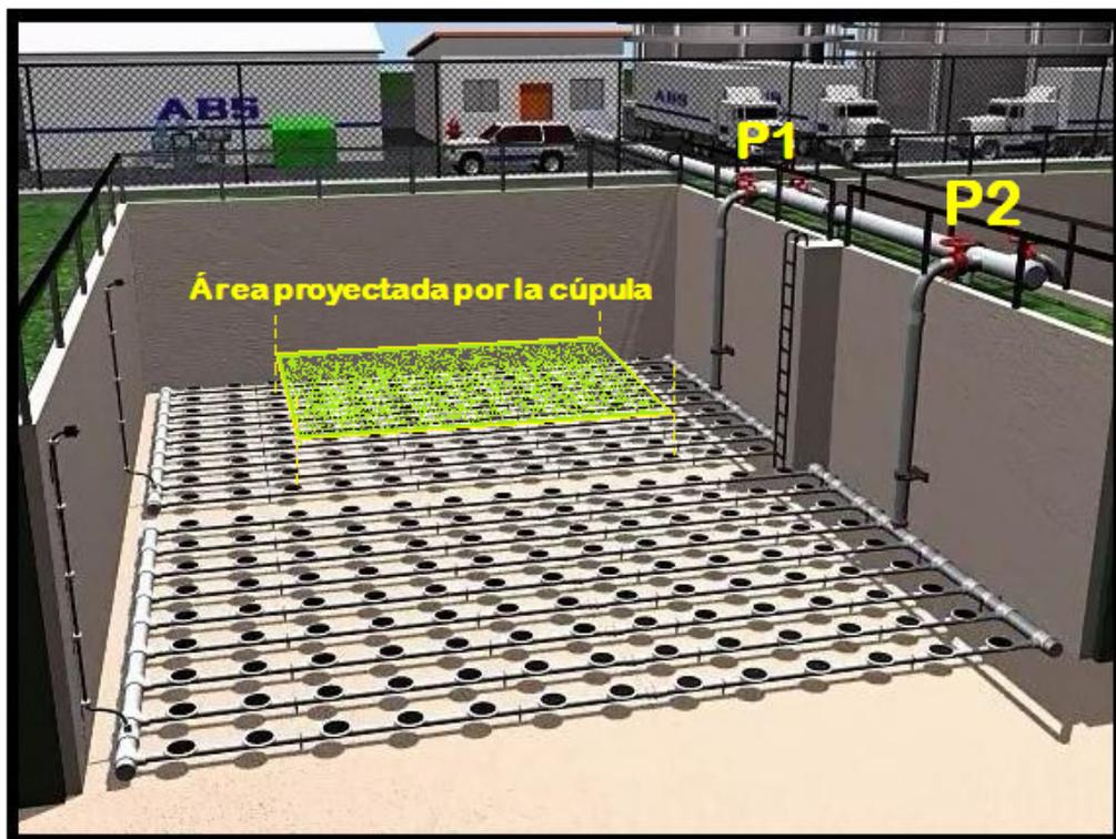
**Figura 33:** Esquema de sistema de distribución de aire en los reactores biológicos de “El Trebal”
