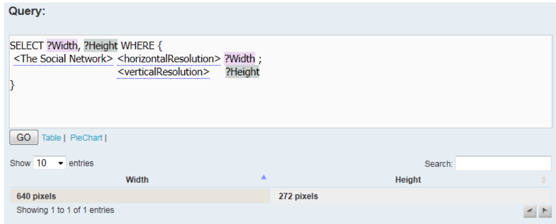
Figura 4.3: Interfaz de consulta web por SPARQL. Esta consulta obtiene el ancho y alto en pixeles de un archivo de video. Se hace uso de etiquetas fácilmente legibles en vez de URIs explícitas lo cual simplifica la construcción de la consulta.
